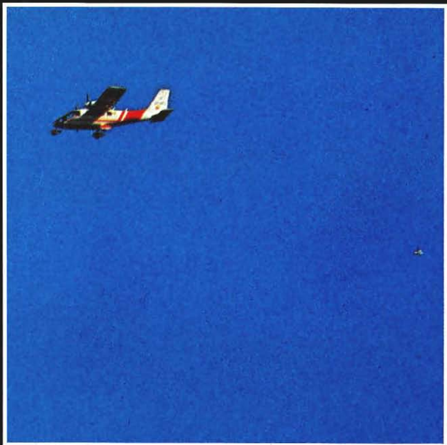
Foto 3: Durant el vol el sensor està penjat uns 30 m darrera de l'avió
