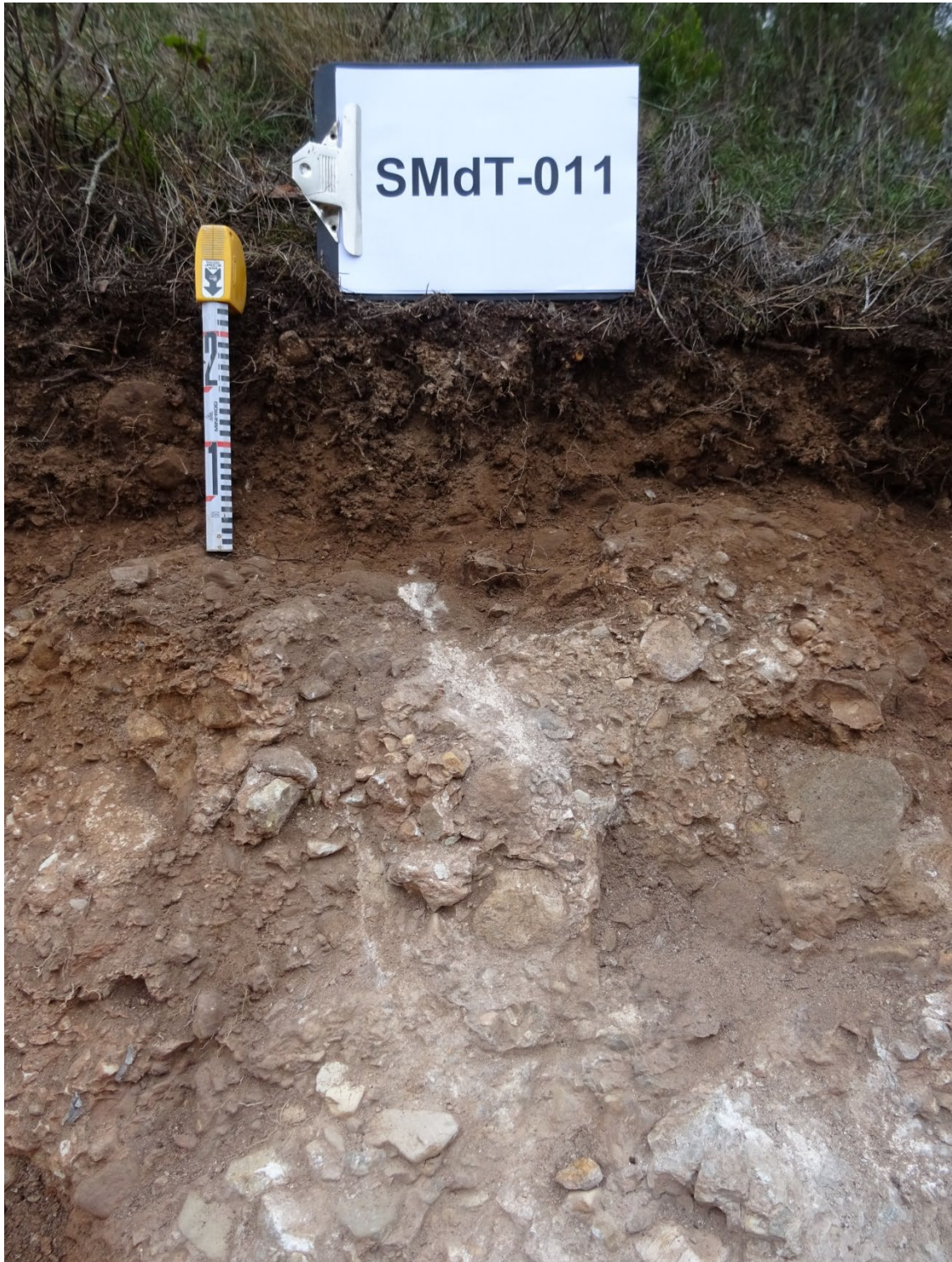
Secuencia de horizontes: Oe-A-R (conglomerado) Cartografía de suelos a escala 1:25.000 de la hoja de Igualada (ICGC, 2018).
