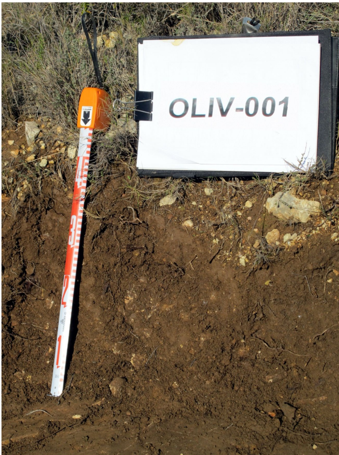
Secuencia de horizontes: A-R (caliza) Cartografía de suelos a escala 1:25.000 de la hoja de St. Pere de Ribes (IGC, 2012)
