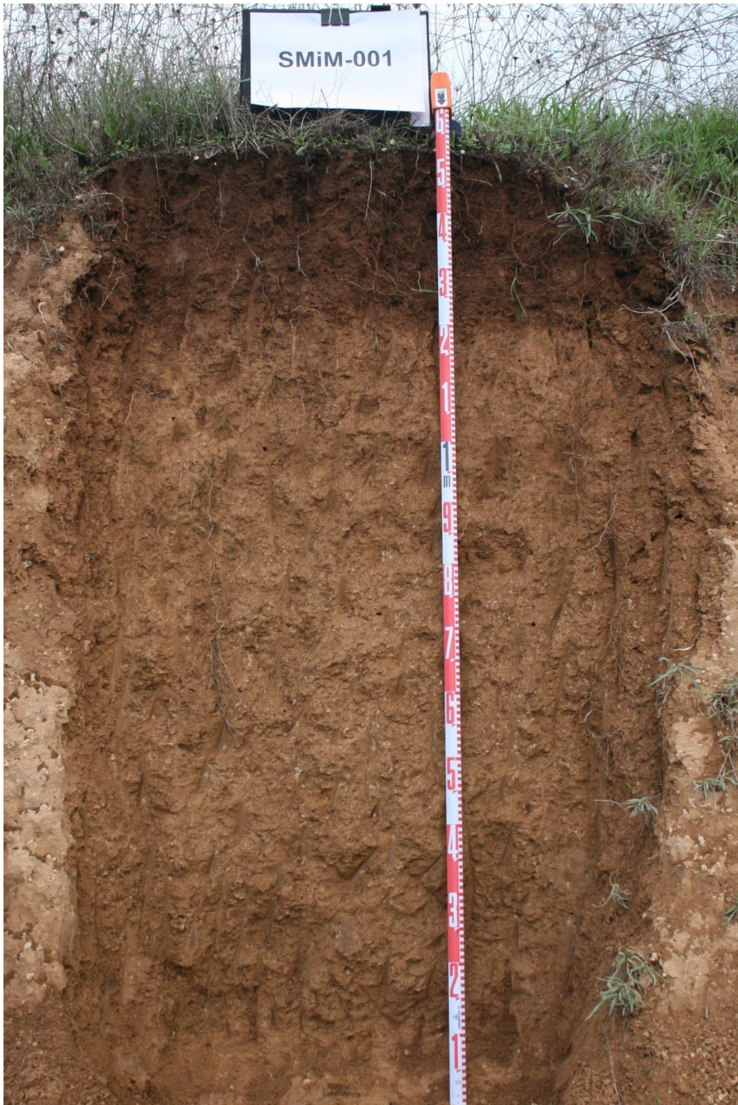
Secuencia de horizontes: Ap-Bwk1-Bwk2 Cartografía de suelos a escala 1:25.000 de la hoja de Vilafranca del Penedès (IGC, 2013)
