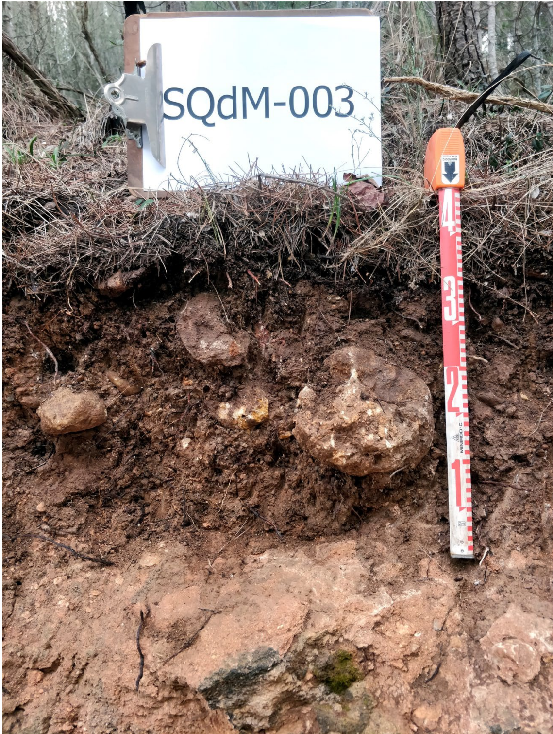
Seqüència d'horitzons: Oi-A-Bkm Cartografia de sòls a escala 1:25.000 del full de Sant Sadurní d'Anoia (ICGC, 2018)
