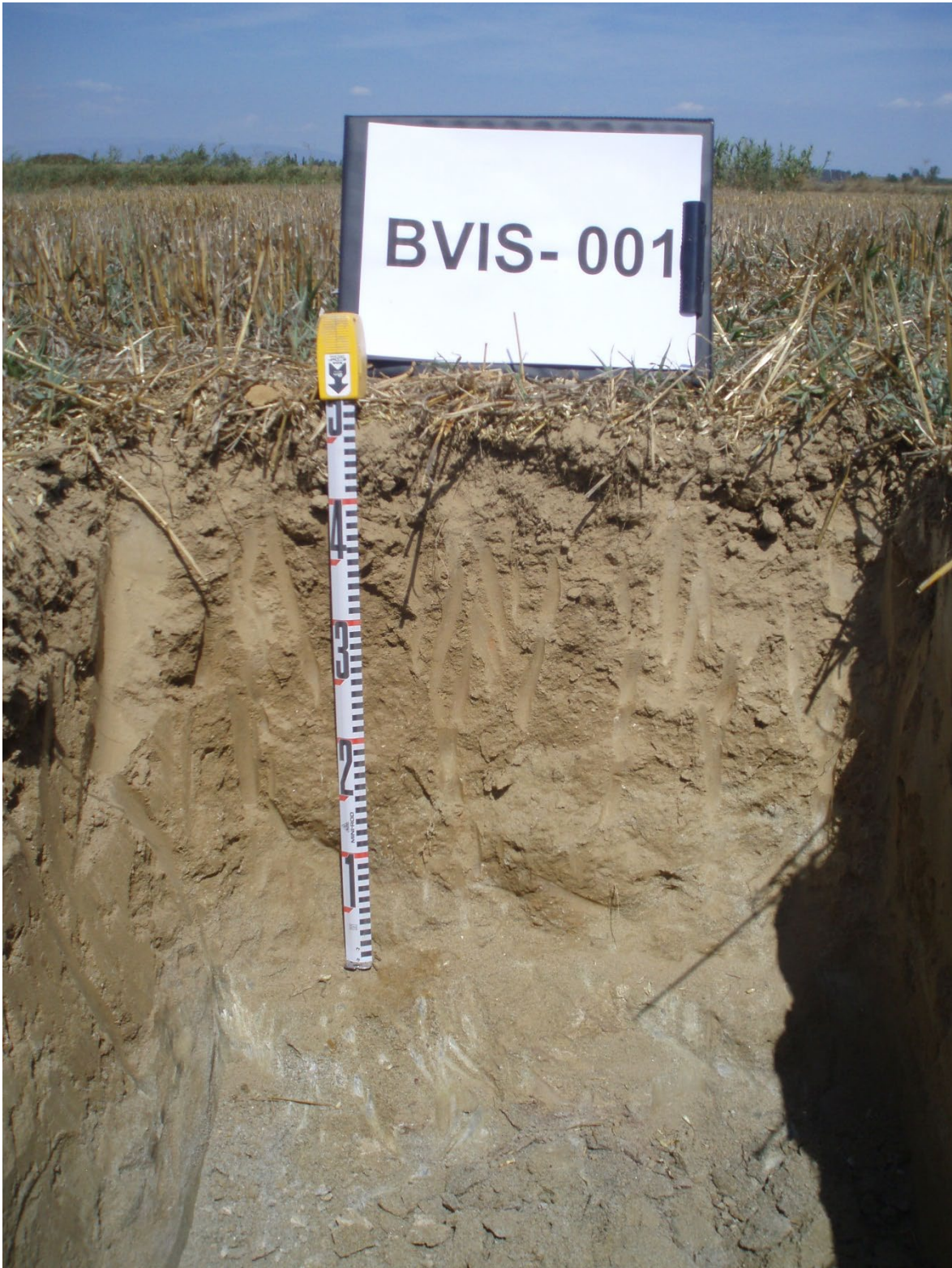
Seqüència d'horitzons: Ap-Bw1-C (gres) Cartografia de sòls a escala 1:25.000 del full de Tèrmens (IGC, 2009).
