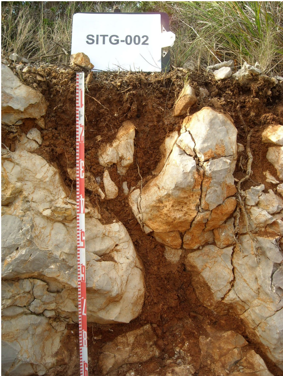
Secuencia de horizontes: A-Bt-R (caliza). Cartografía de suelos a escala 1:25.000 de la hoja de Castelldefels-Vallcarca (IGC, 2013)
