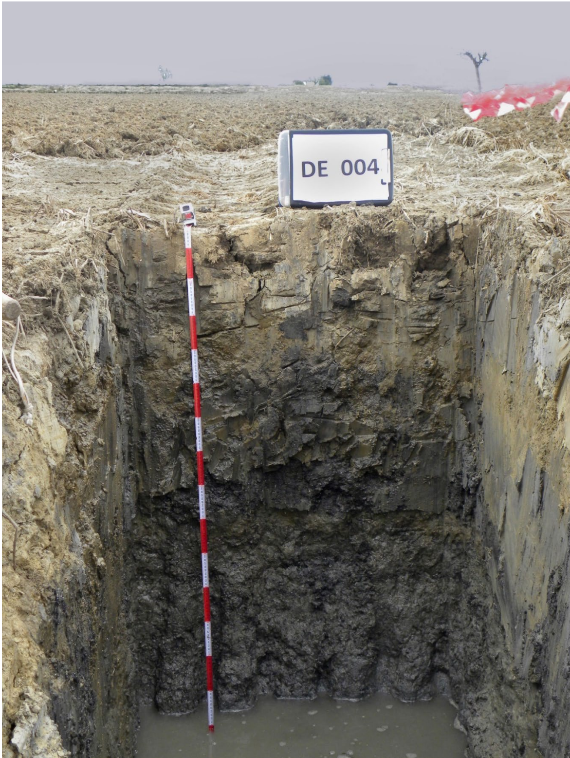
Seqüència d'horitzons: Ap-(Apdg)-Bwg-(H) Estudi de sòls (a escala 1:250.000) del Delta de l'Ebre (IGC, 2010)
