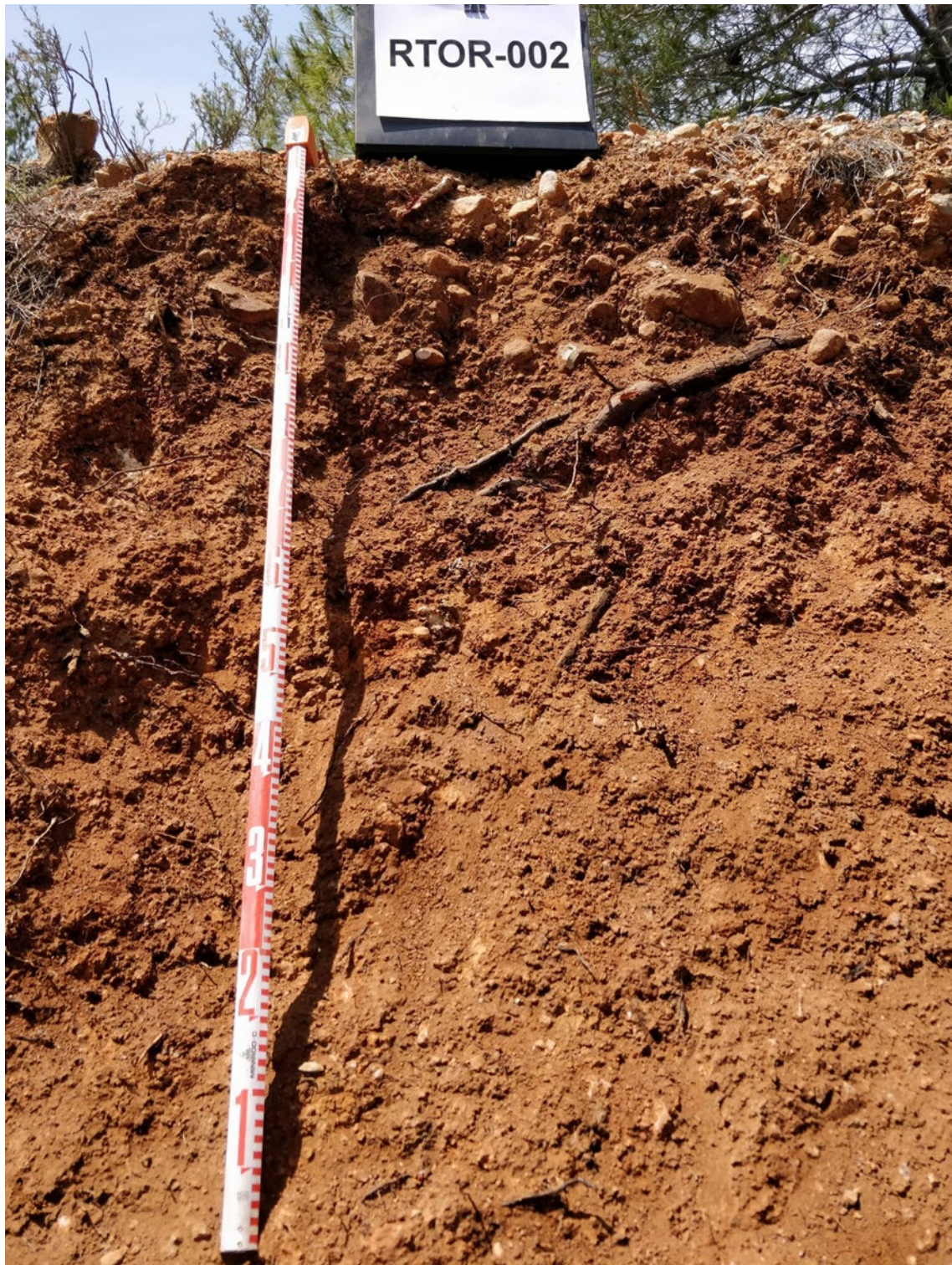
Seqüència d'horitzons: A-Btk-Btk(m) Cartografia de sòls a escala 1:25.000 del full de Tortosa (63-39 / 522-1-1) (ICGC, 2019).
