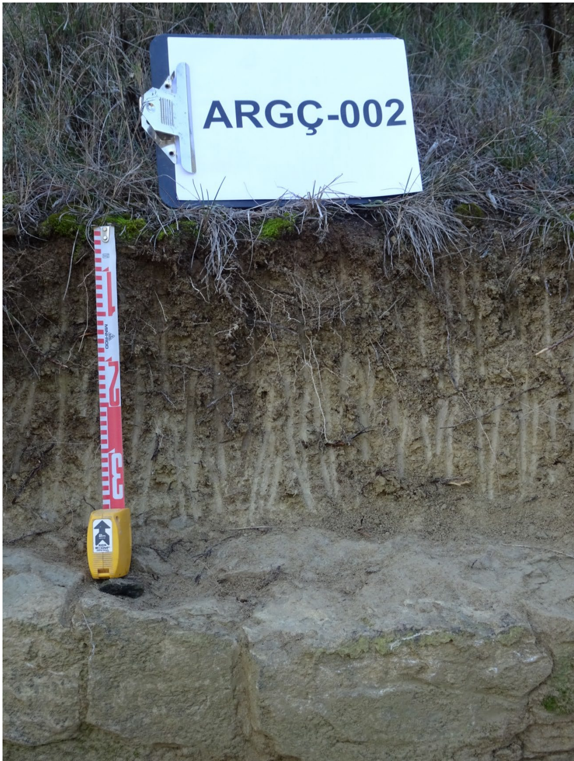
Secuencia de horizontes: Oe-A-R (arenisca calcárea) Cartografía de suelos a escala 1:25.000 de la hoja de Igualada (ICGC, 2018).
