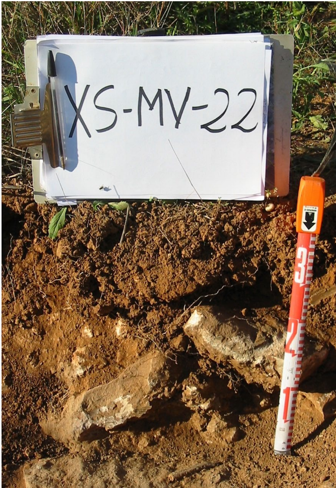
Secuencia de horizontes: Ap-Bkm Cartografía de suelos a escala 1:25.000 de la hoja de Amposta (ICGC, 2014).
