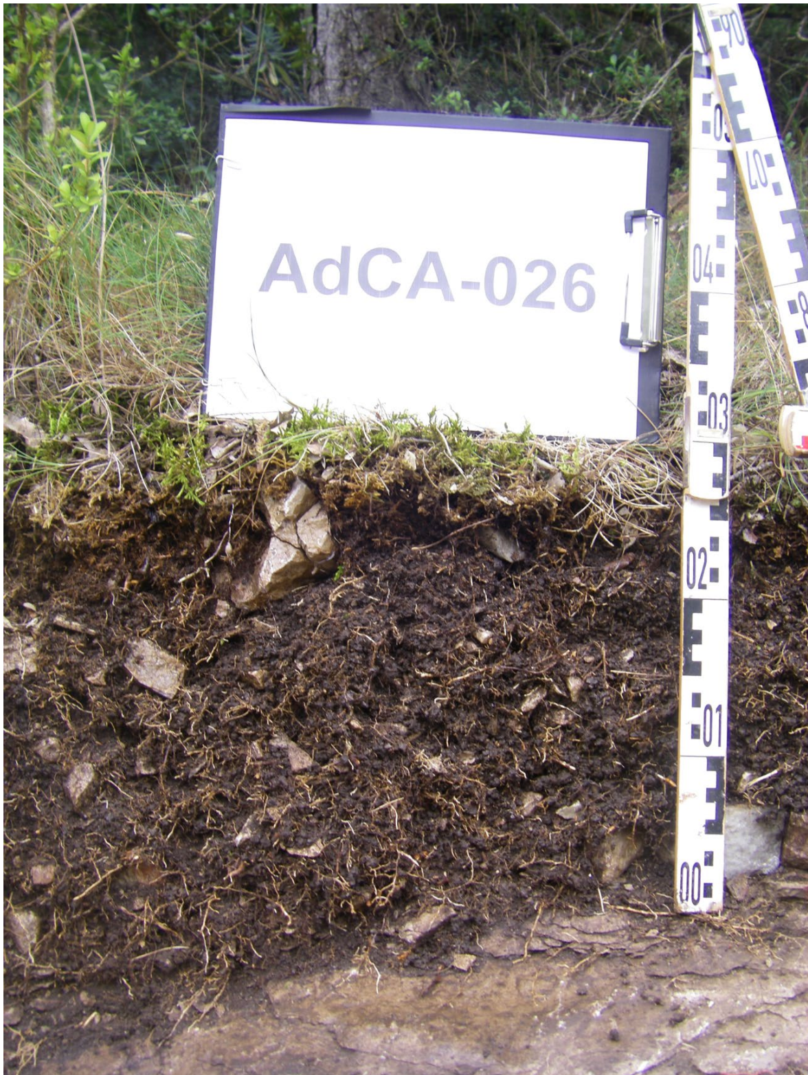
Seqüència d'horitzons: O-A-R (calcària). Cartografia de sòls a escala 1:25.000 del full de Caro (ICGC, 2014).
