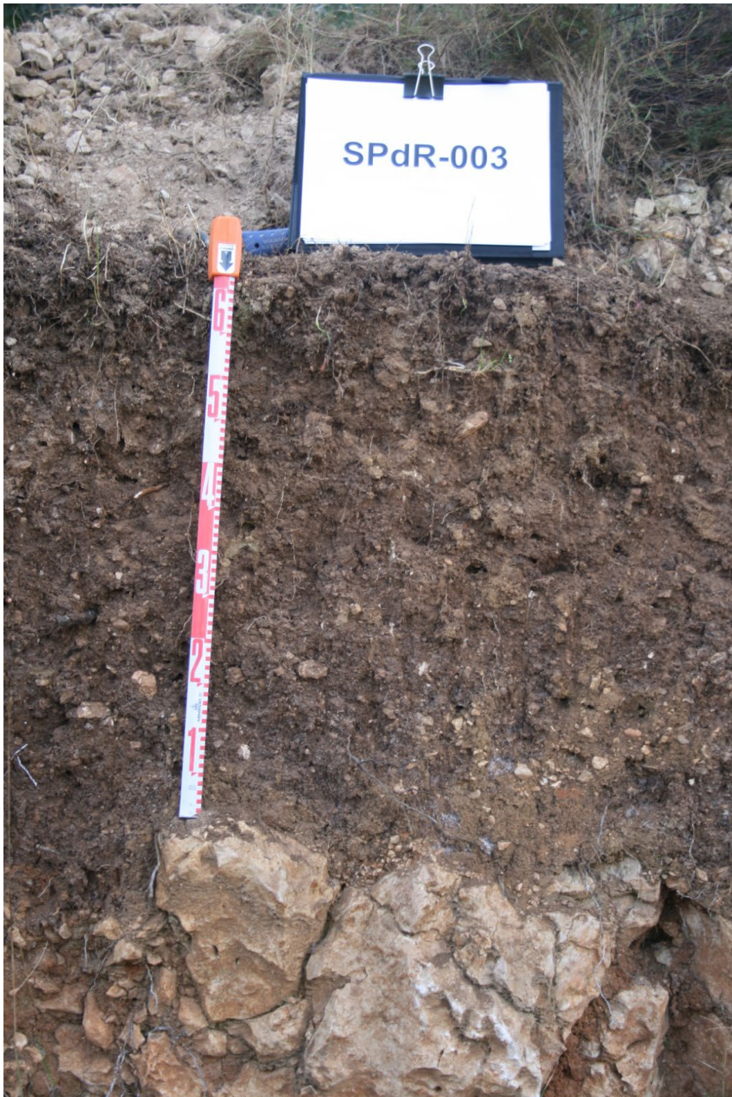
Secuencia de horizontes: O-Ap-Bwk-R(k)(caliza) Cartografía de suelos a escala 1:25.000 de la hoja de Sant Pere de Ribes (IGC, 2012)
