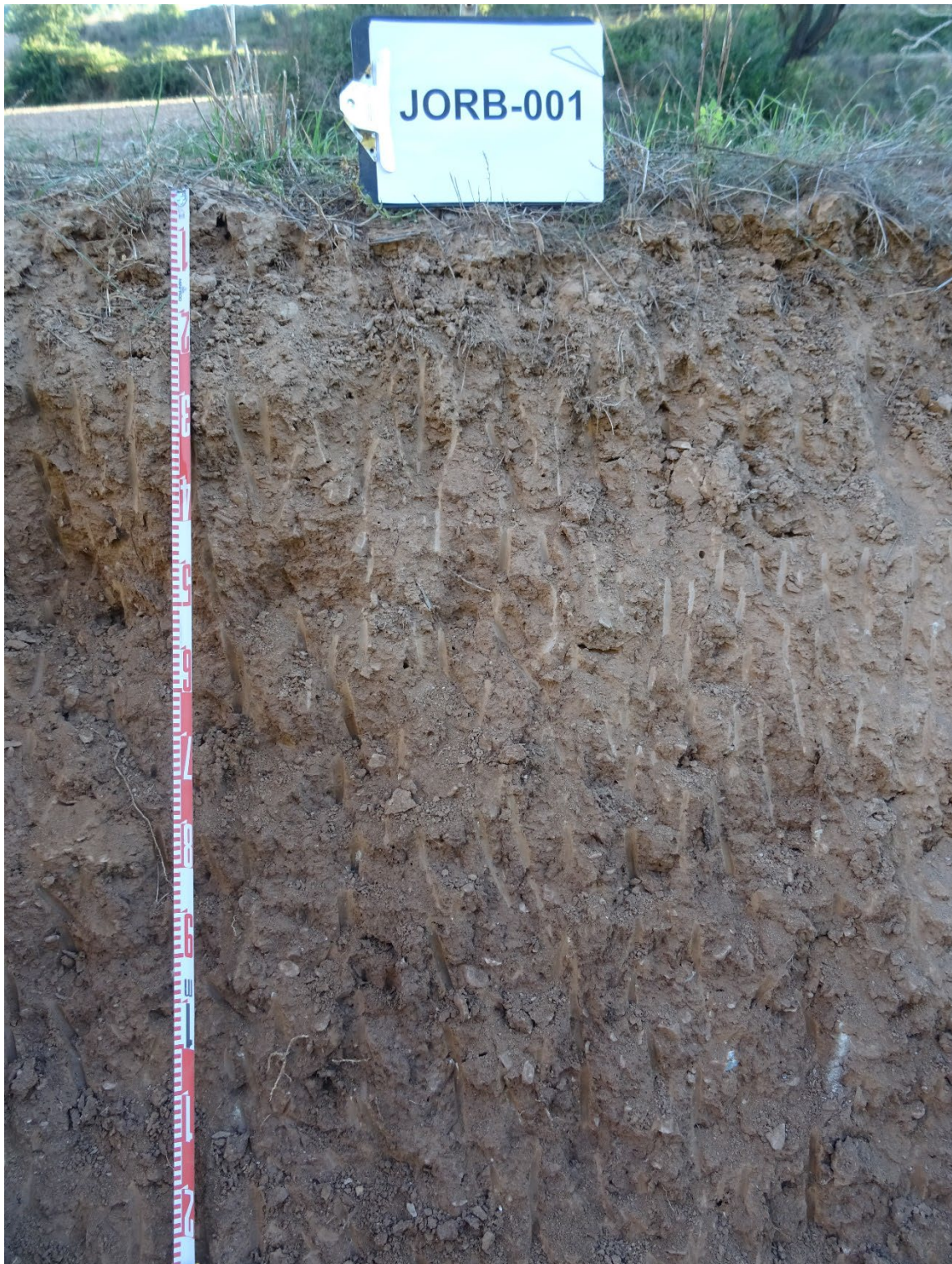
Seqüència d'horitzons: Ap-Bw-2Ab Cartografia de sòls a escala 1:25.000 del full d'Òdena (63-29 / 391-1-1) (ICGC, 2019).
