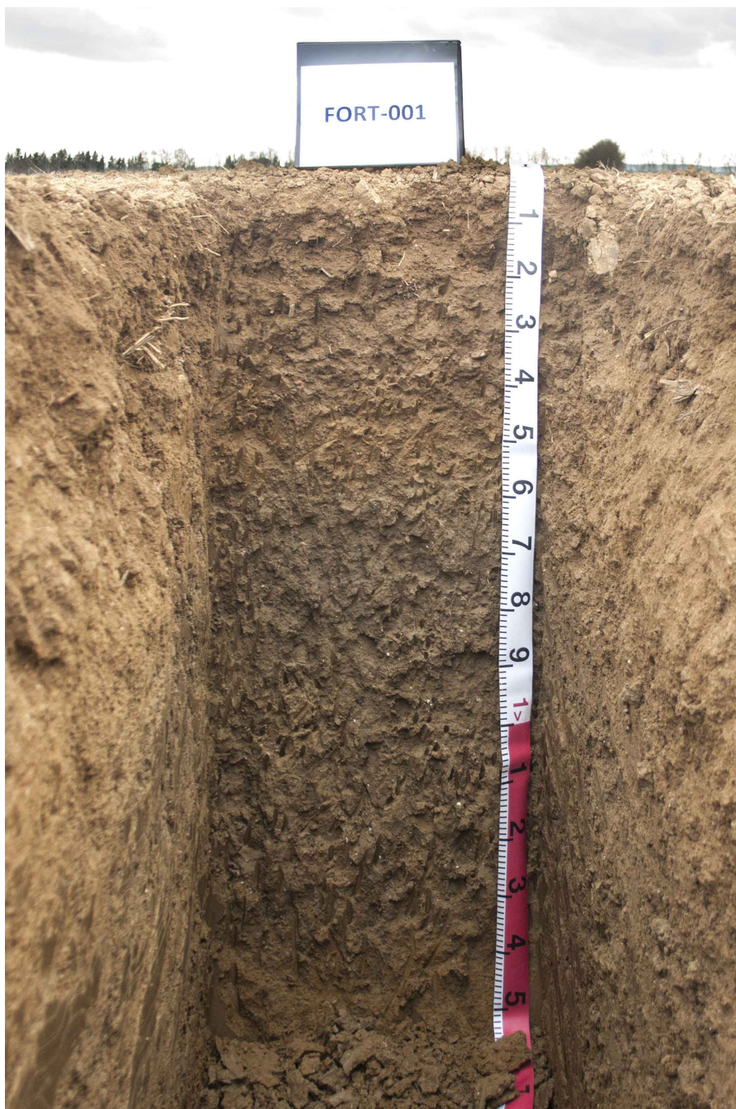
Seqüència d'horitzons: Ap-Bw-Bwk-Bw Cartografia de sòls a escala 1:25.000 del full de Castelló d'Empúries (ICGC, 2025)
