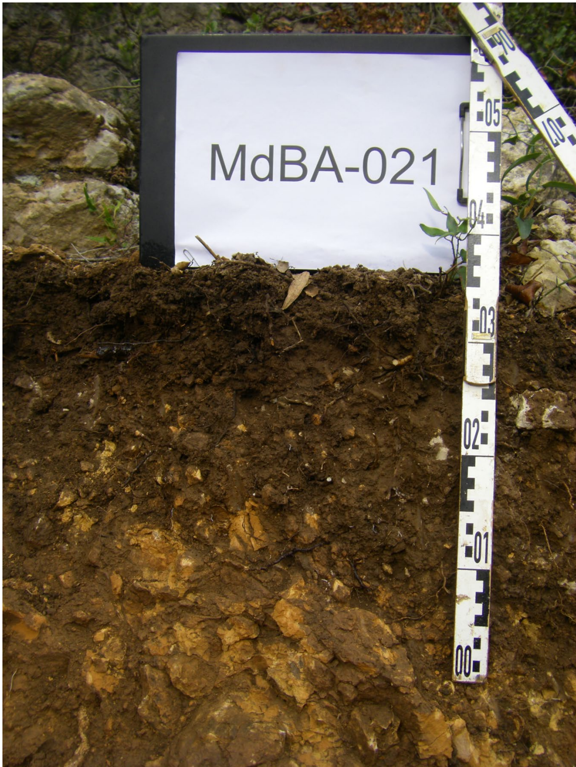
Seqüència d'horitzons: (O)-A-(Bw)-R (calcària). Cartografia de sòls a escala 1:25.000 del full de Caro (ICGC, 2014).
