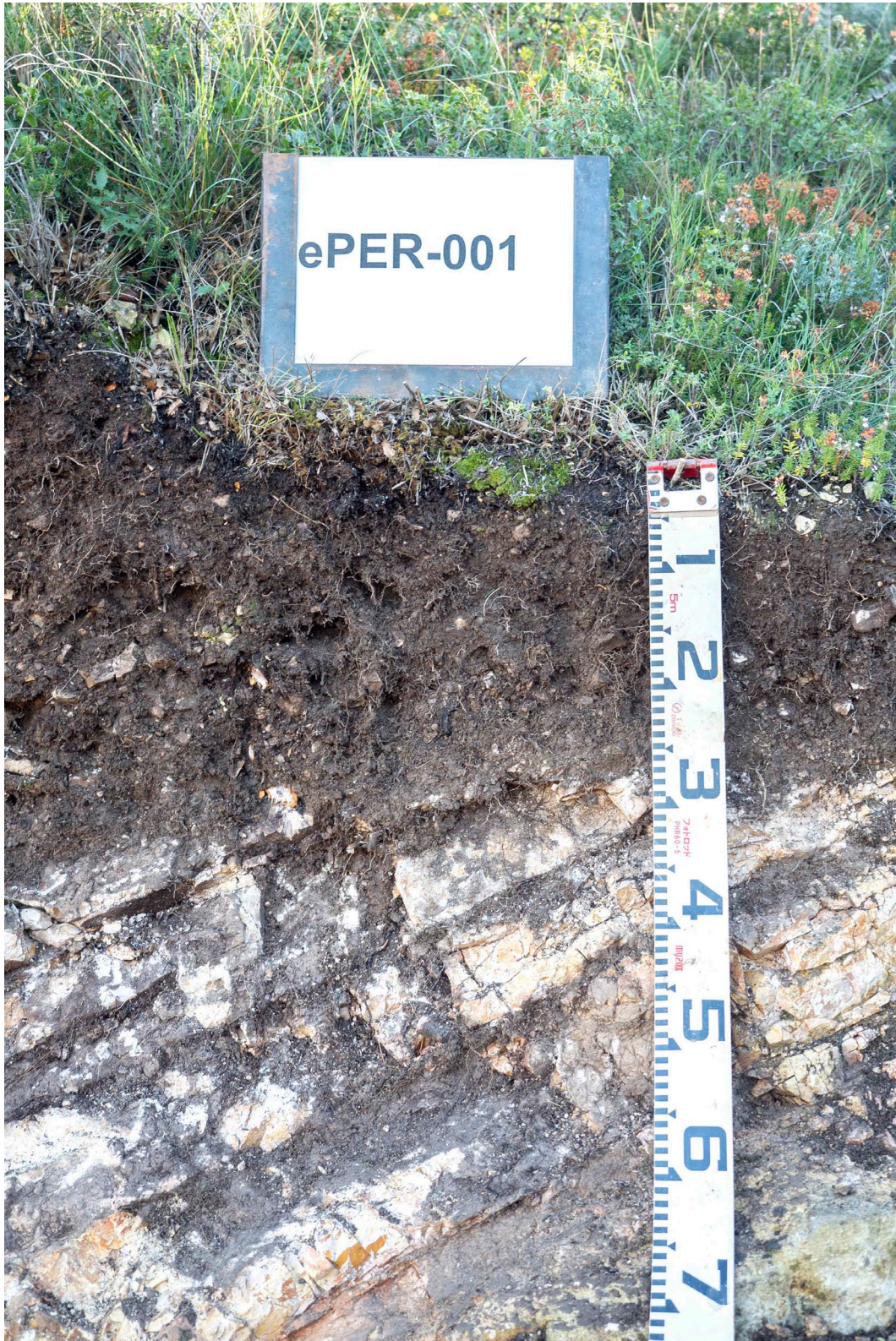
Seqüència d'horitzons: A-Bw-R (calcària) Cartografia de sòls a escala 1:25.000 del full de Xerta (ICGC,2020)
