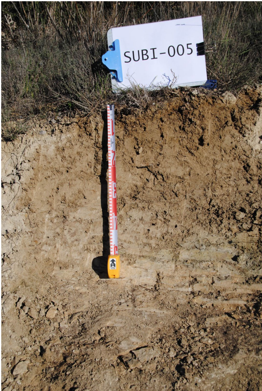
Seqüència d'horitzons: A-C (lutita) Cartografia de sòls a escala 1:25.000 del full de Vilafranca del Penedès (IGC, 2013)
