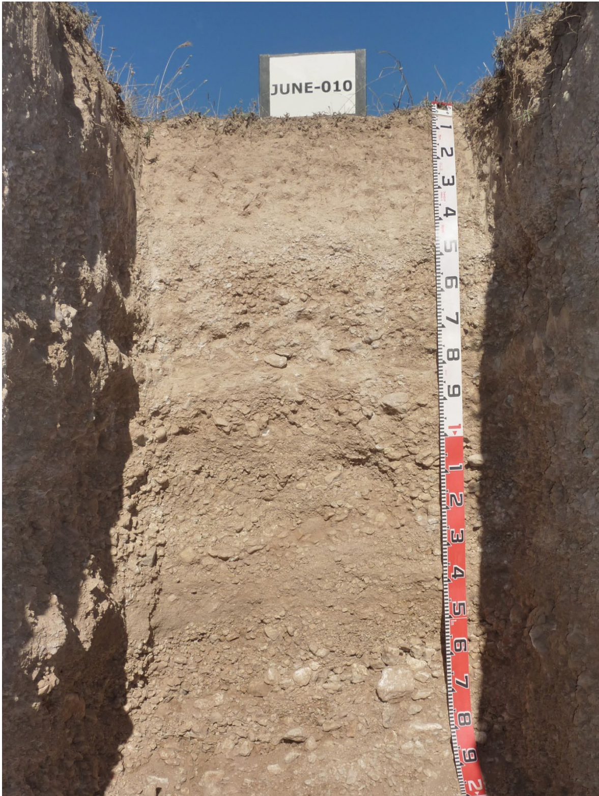
Secuencia de horizontes: Ap-Bwk-2Bk (gravas) Cartografía de suelos a escala 1:25.000 de la hoja de las Borges Blanques (IGC, 2010)
