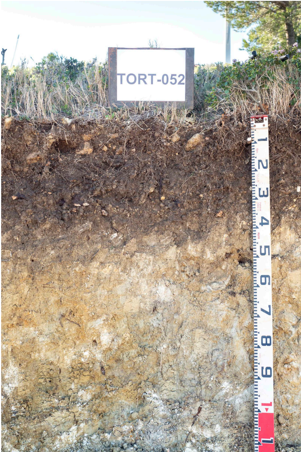
Secuencia de horizontes: Oi-A-Bw-C (lutita) Cartografía de suelos a escala 1:25.000 de la hoja de Xerta (ICGC,2020)
