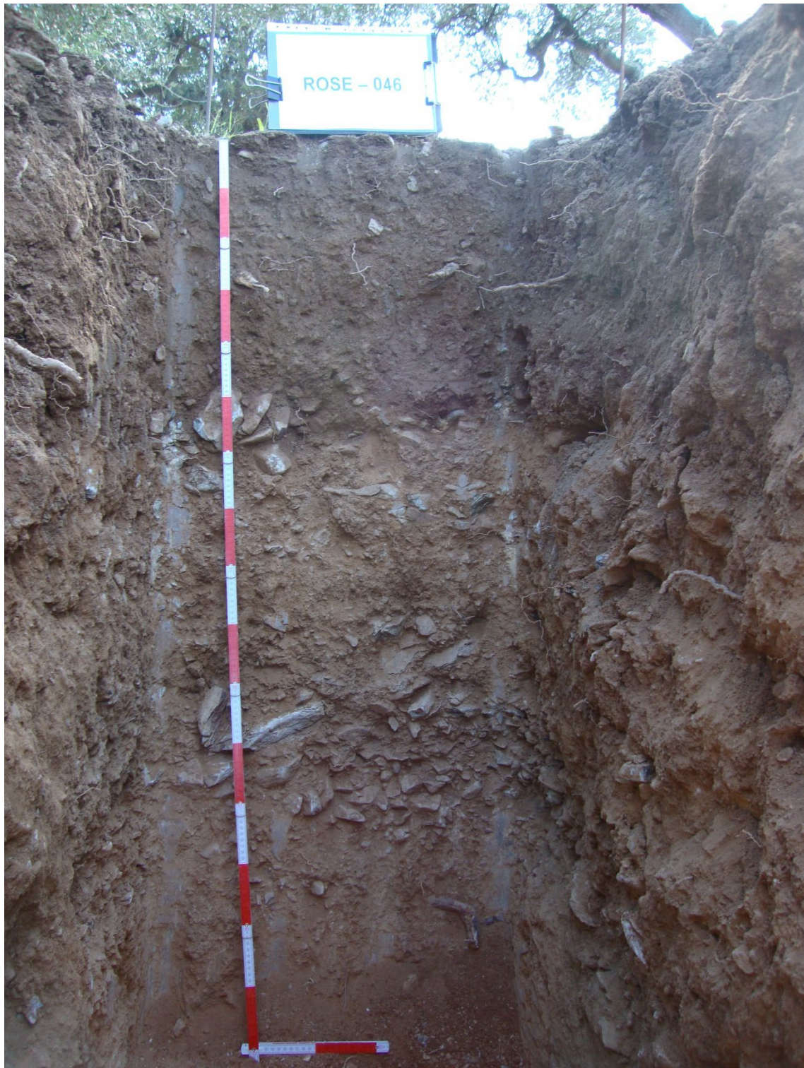
Seqüència d'horitzons: A-Bw-C1 (graves)-C2 (graves) Cartografia de sòls a escala 1:25.000 del full de Roses, Cap de Creus i Far de Roses. (ICGC, 2016).
