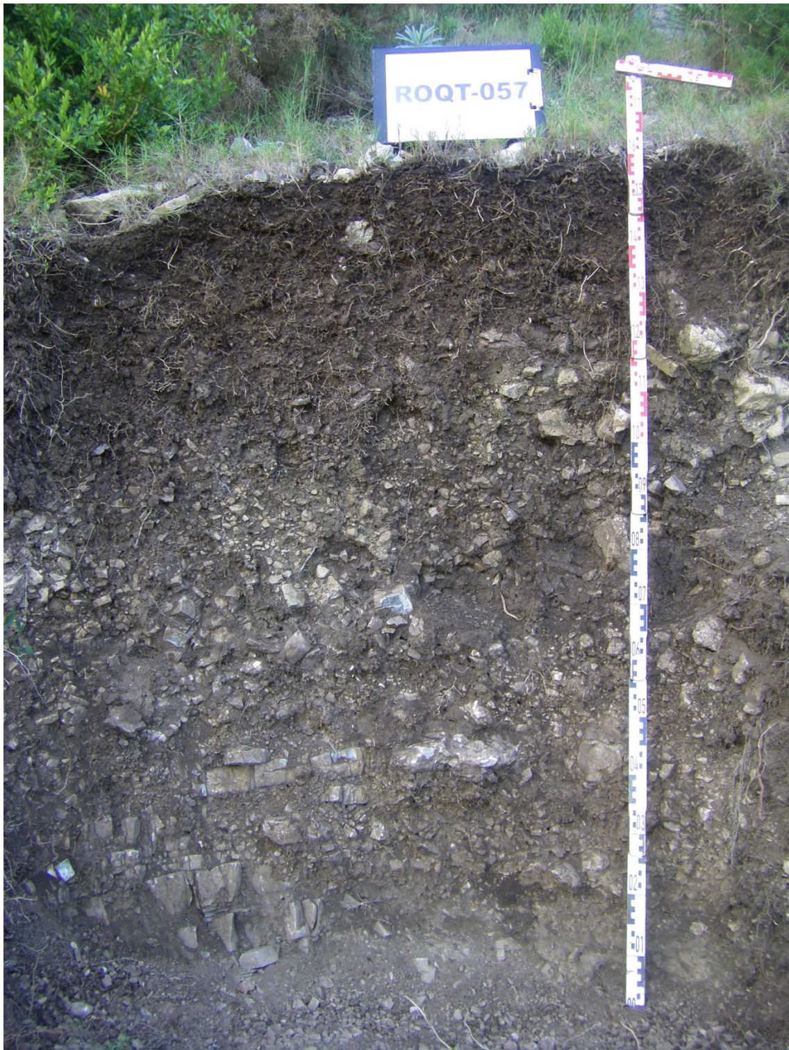
Secuencia de horizontes: O-A-Bw Cartografía de suelos a escala 1:25.000 de la hoja de Caro (ICGC, 2014).
