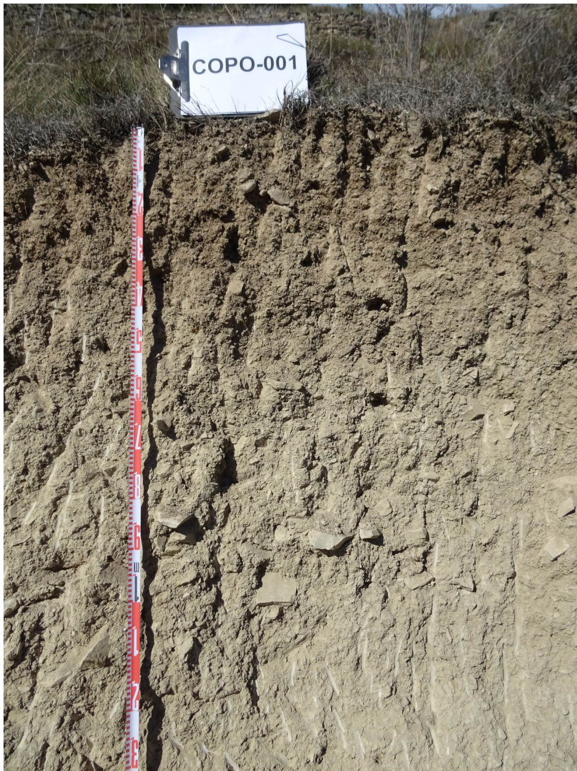
Seqüència d'horitzons: Ap-Bw-Bwk Cartografia de sòls a escala 1:25.000 del full d'Òdena (63-29 / 391-1-1) (ICGC, 2019).
