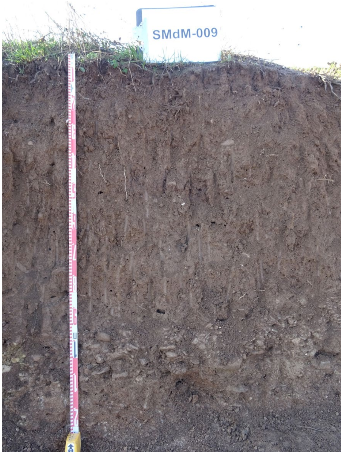
Seqüència d'horitzons: Ap-Bw-Bk Cartografia de sòls a escala 1:25.000 del full d'Igualada (ICGC, 2018).
