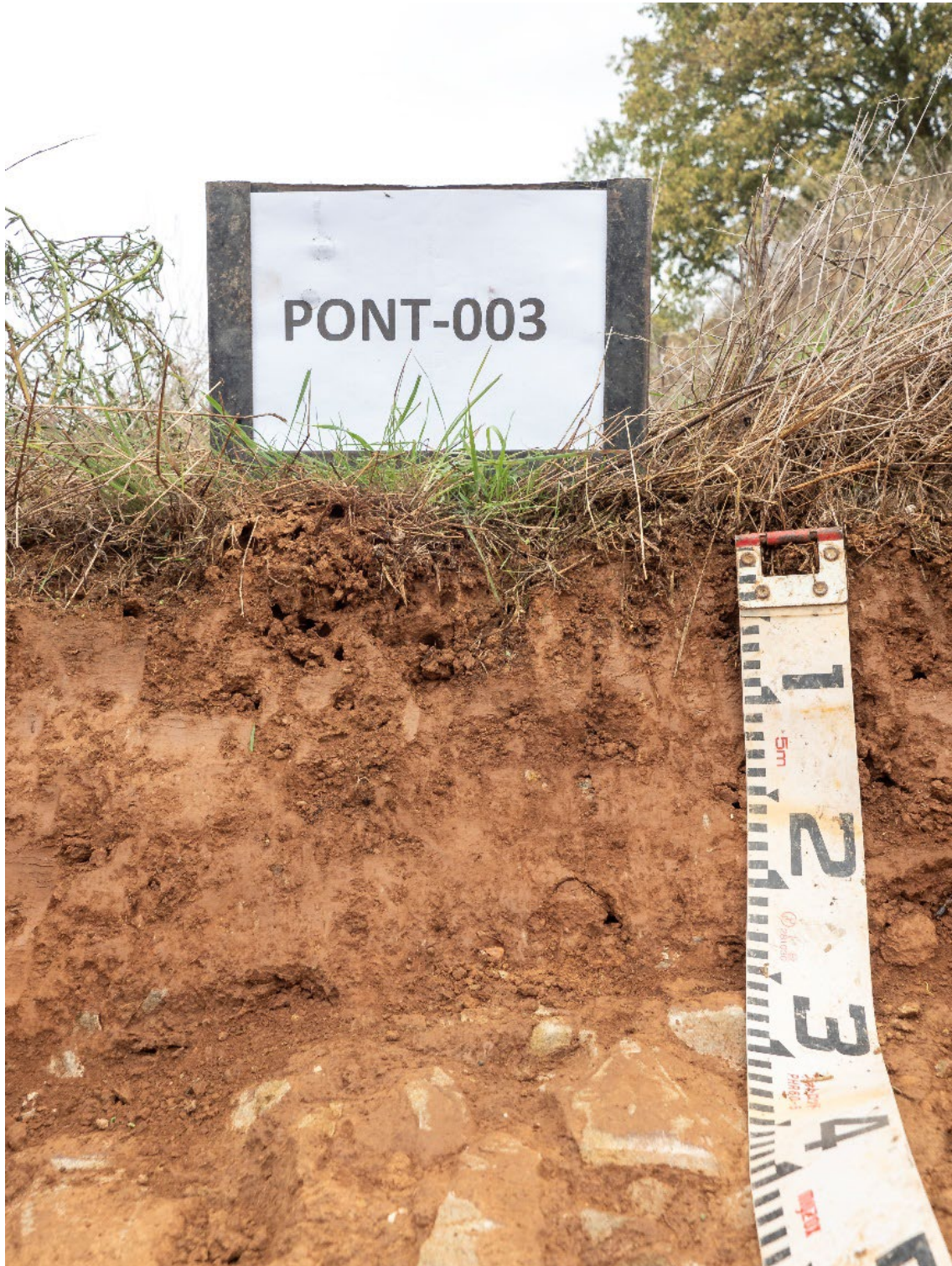
Seqüència d'horitzons: Ap-R (gres). Cartografia de sòls a escala 1:25.000 del full d'Artesa de Segre (ICGC, 2024).
