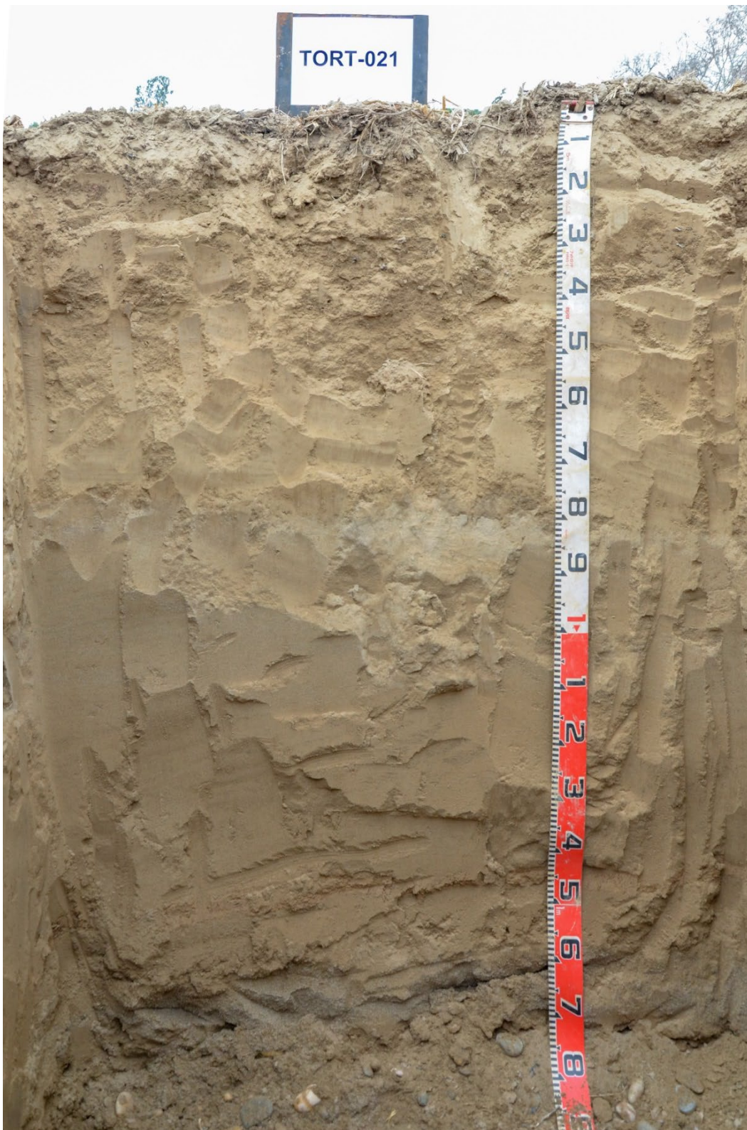
Seqüència d'horitzons: Ap-Bw-C1 (dipòsits al·luvials)-C2 (dipòsits al·luvials) Cartografia de sòls a escala 1:25.000 del full de Tortosa (63-39 / 522-1-1) (ICGC, 2019).
