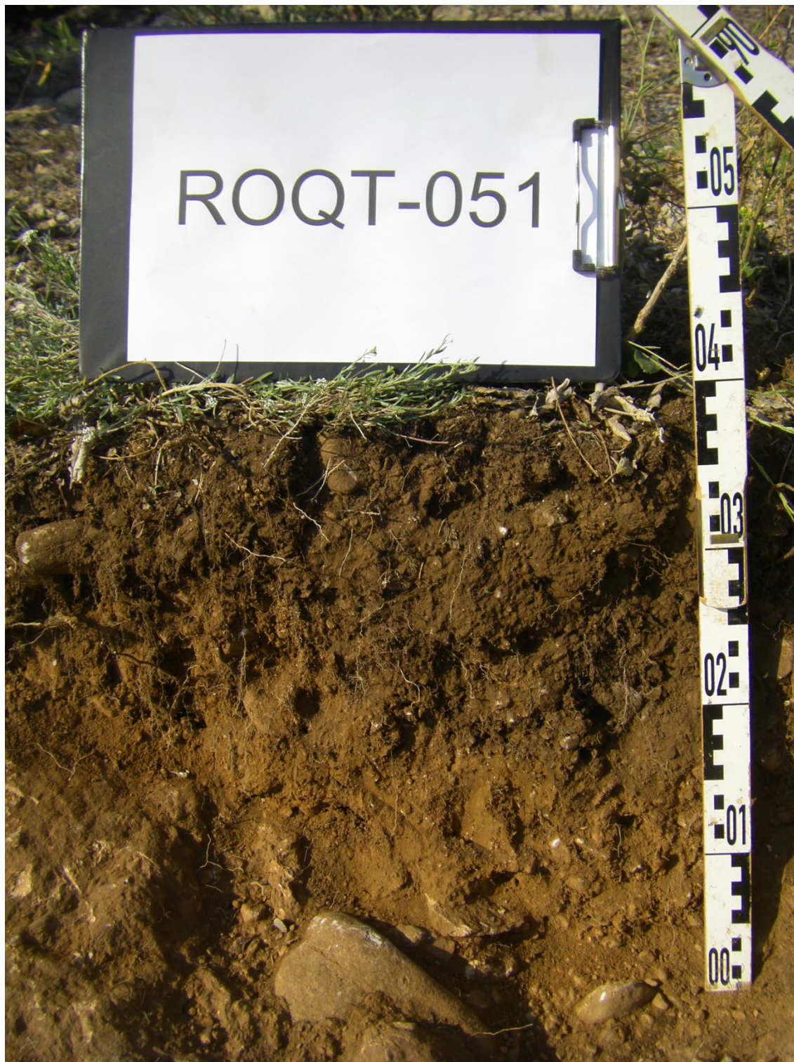
Secuencia de horizontes: Ap-Bkm Cartografía de suelos a escala 1:25.000 de la hoja de Caro (ICGC, 2014).
