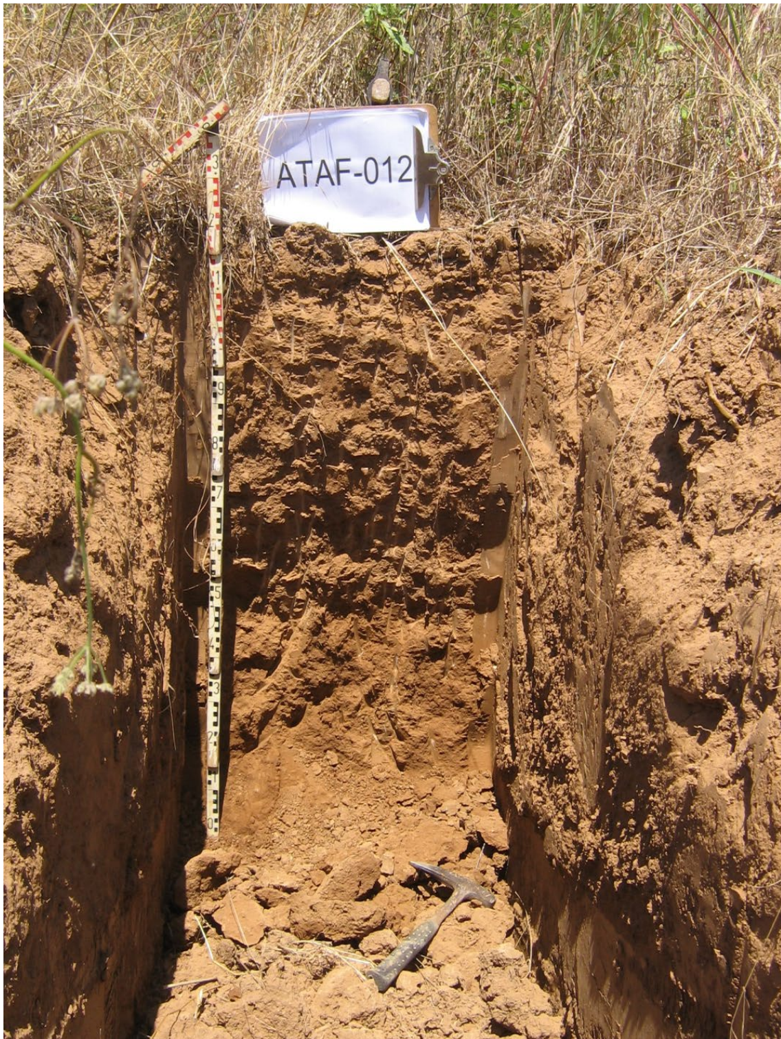
Seqüència d'horitzons: Ap-Bw1-Bw2 Cartografia de sòls a escala 1:25.000 del full de Roda de Barà (IGC, 2011)
