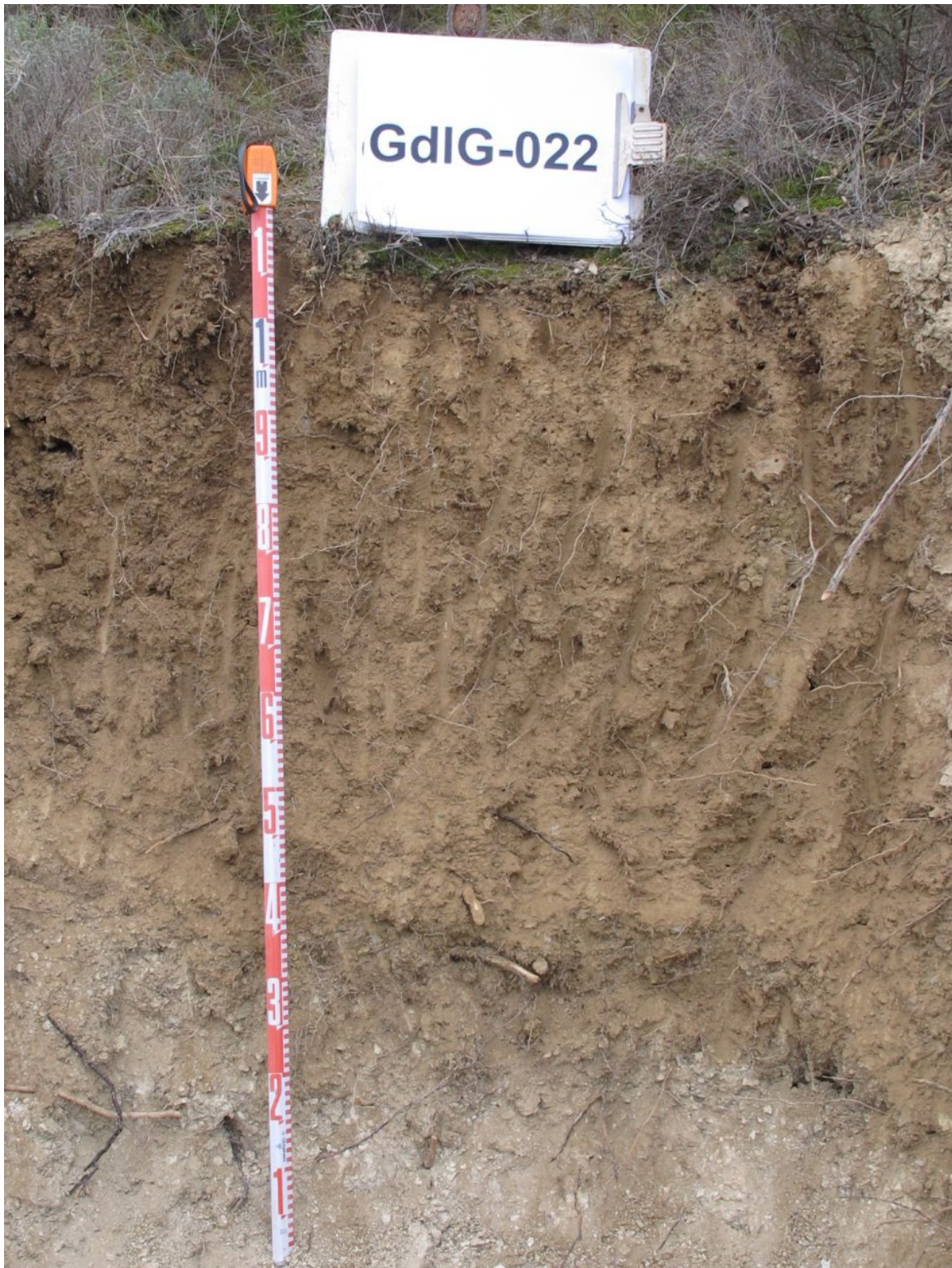
Seqüència d'horitzons: Ap-Bw-Bwkn-Ck(lutita) Cartografia de sòls a escala 1:25.000 del full de Casteldans (IGC, 2011)
