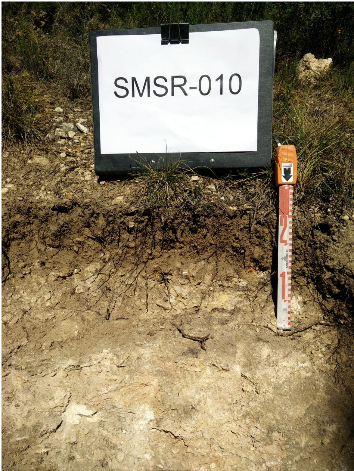
Seqüència d'horitzons: A-B/Ck-Ck(m). Cartografia de sòls a escala 1:25.000 del full de Sant Martí Sarroca (69-32 / 419-1-2) (ICGC, 2015).
