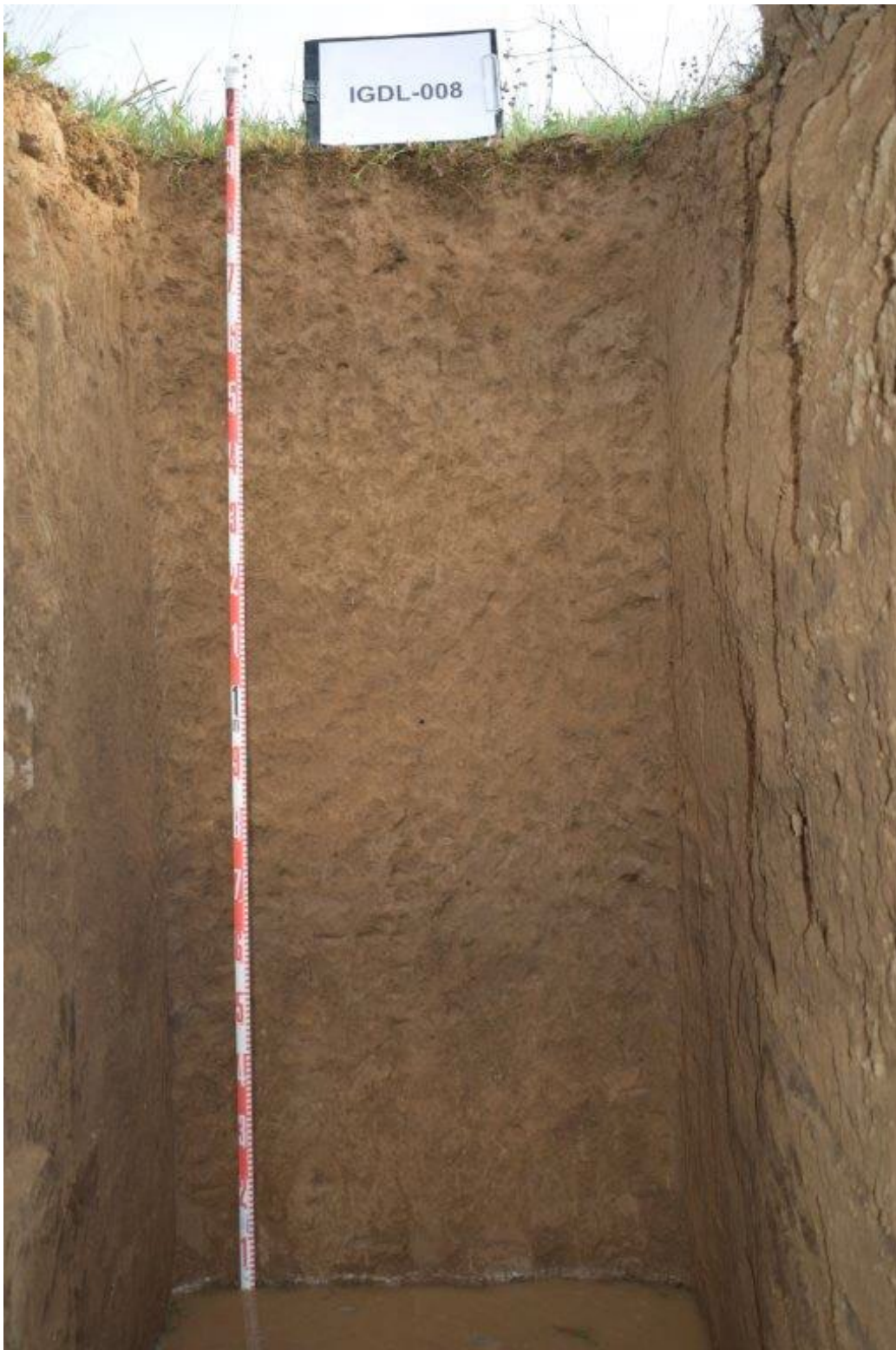
Seqüència d'horitzons: Ap-Bw-Bw2 Cartografia de sòls a escala 1:25.000 del full de Maials (ICGC, 2021)
