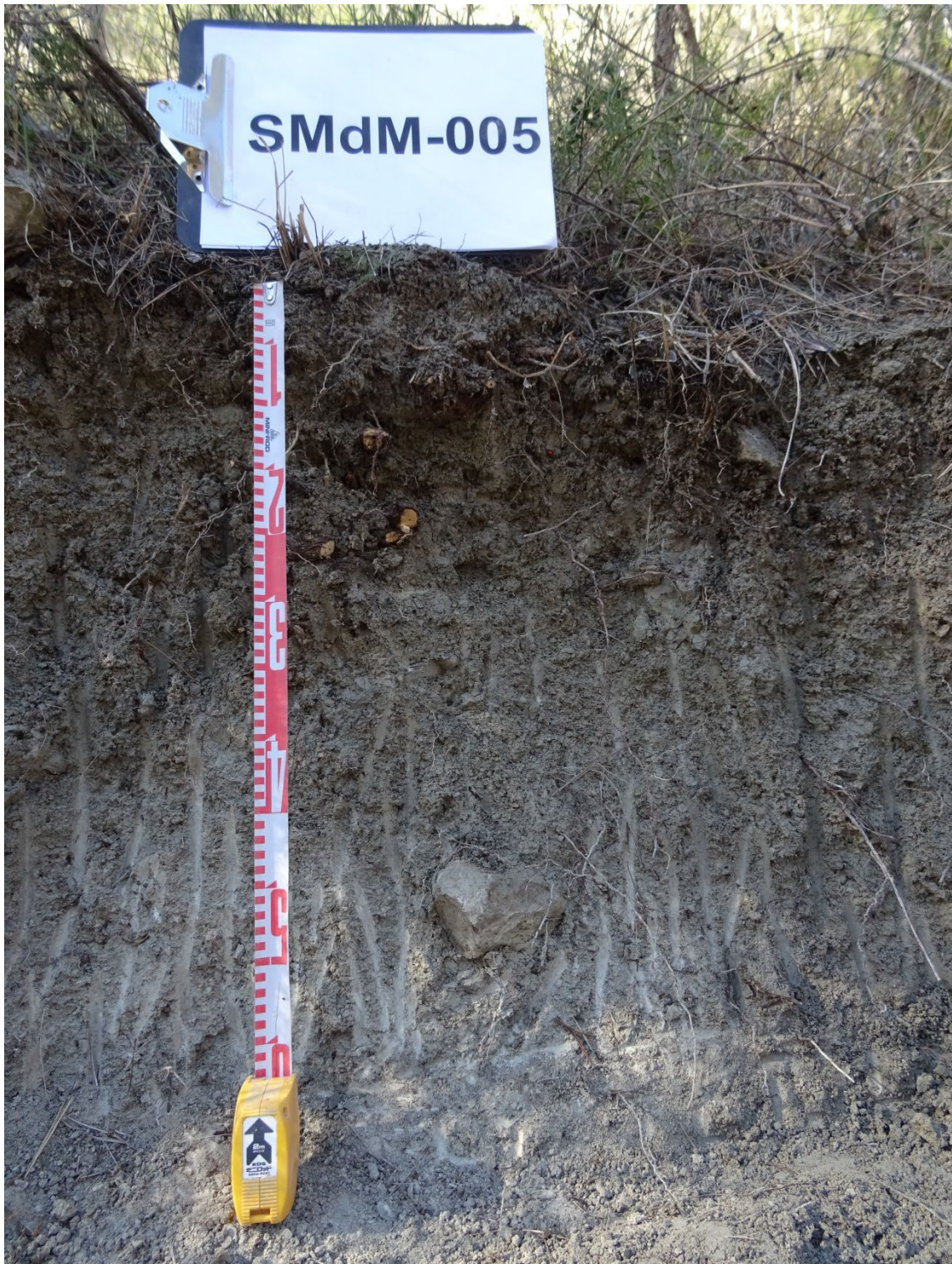
Seqüència d'horitzons: A-C (lutita blava) Cartografia de sòls a escala 1:25.000 del full d'Igualada (ICGC, 2018)
