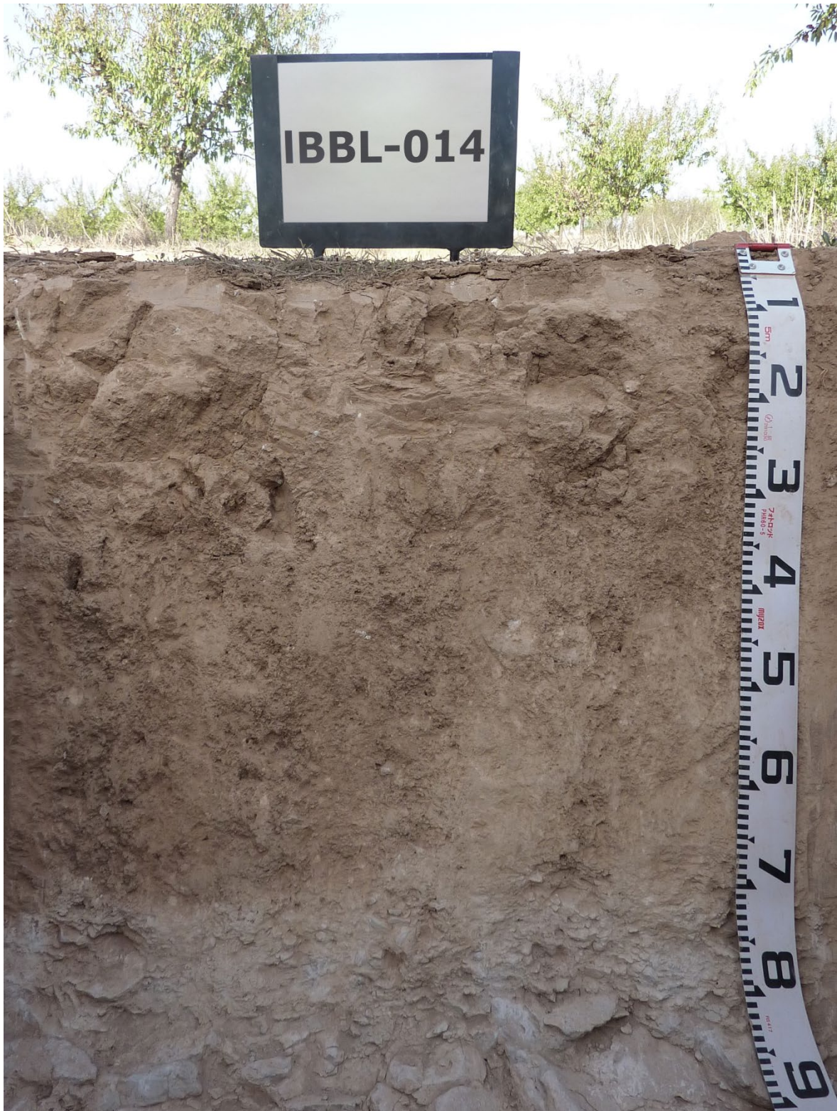
Seqüència d'horitzons: Ap-Bwkn-R(calcària) Cartografia de sòls a escala 1:25.000 del full de les Borges Blanques (IGC, 2010)
