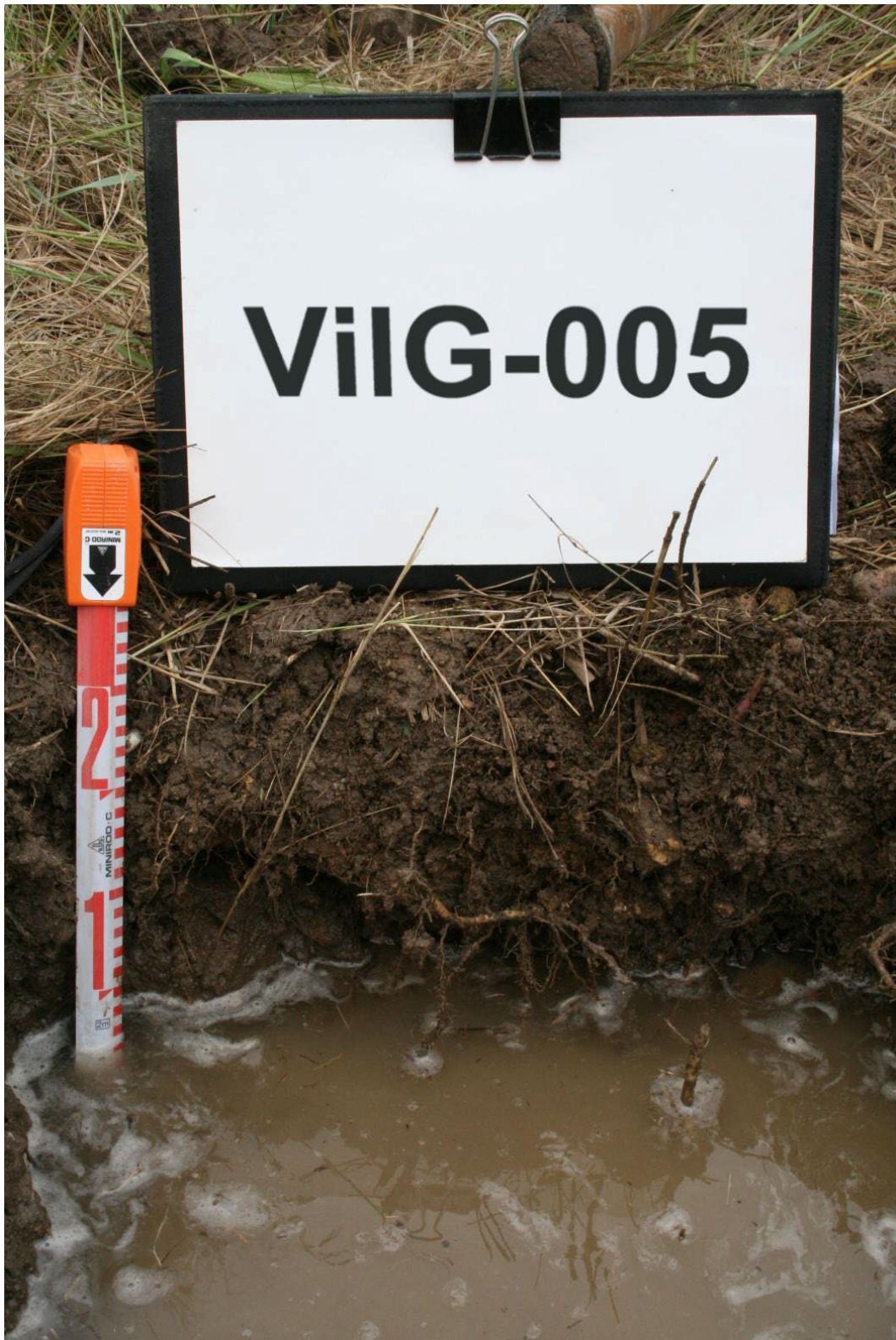
Secuencia de horizontes: A-B-Bg Cartografía de suelos a escala 1:25.000 de la hoja de Vilanova i la Geltrú (IGC, 2013)
