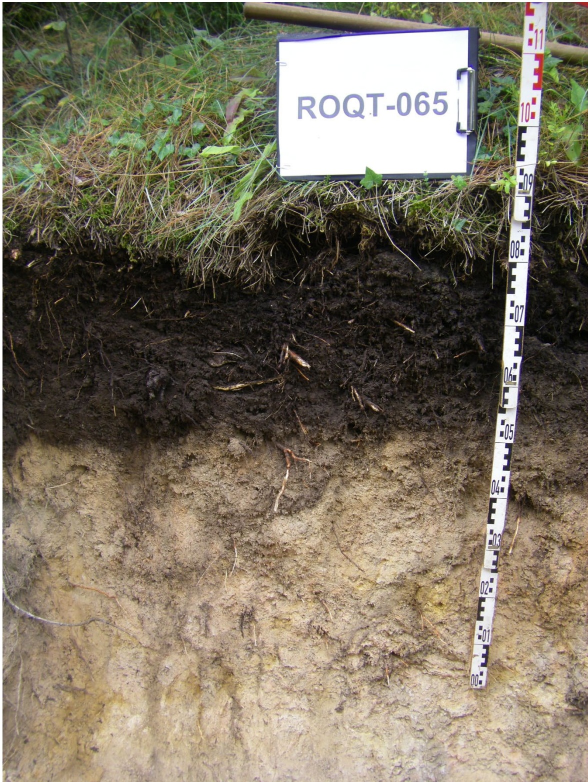
Secuencia de horizontes: Oi-A-Bw-C (caliza meteorizada)-R (caliza). Cartografía de suelos a escala 1:25.000 de la hoja de Caro (ICGC, 2014).
