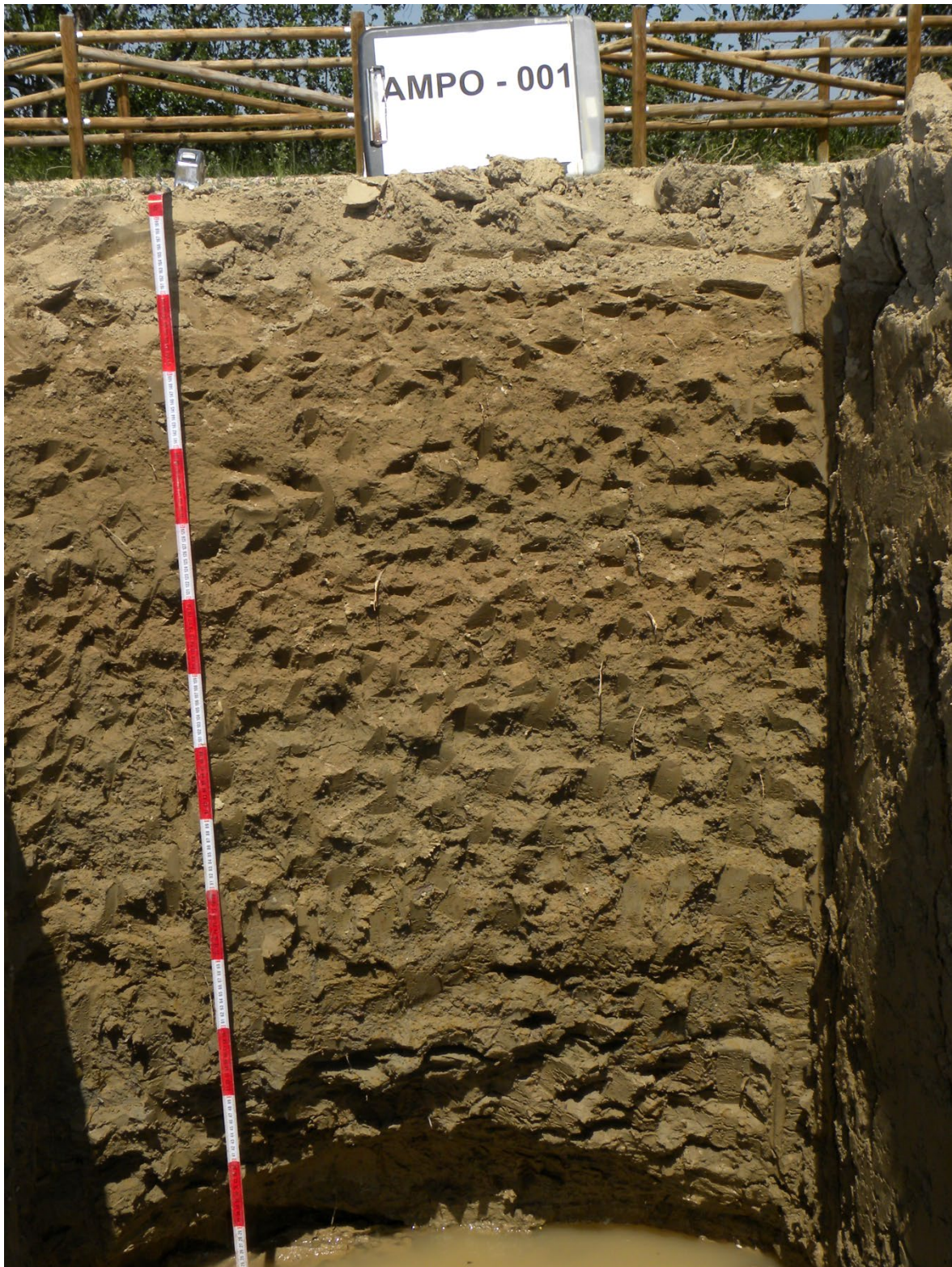
Seqüència d'horitzons: Ap1-Apd-Bw1-Bw2-C Cartografia de sòls a escala 1:25.000 del full d'Amposta (ICGC, 2014).
