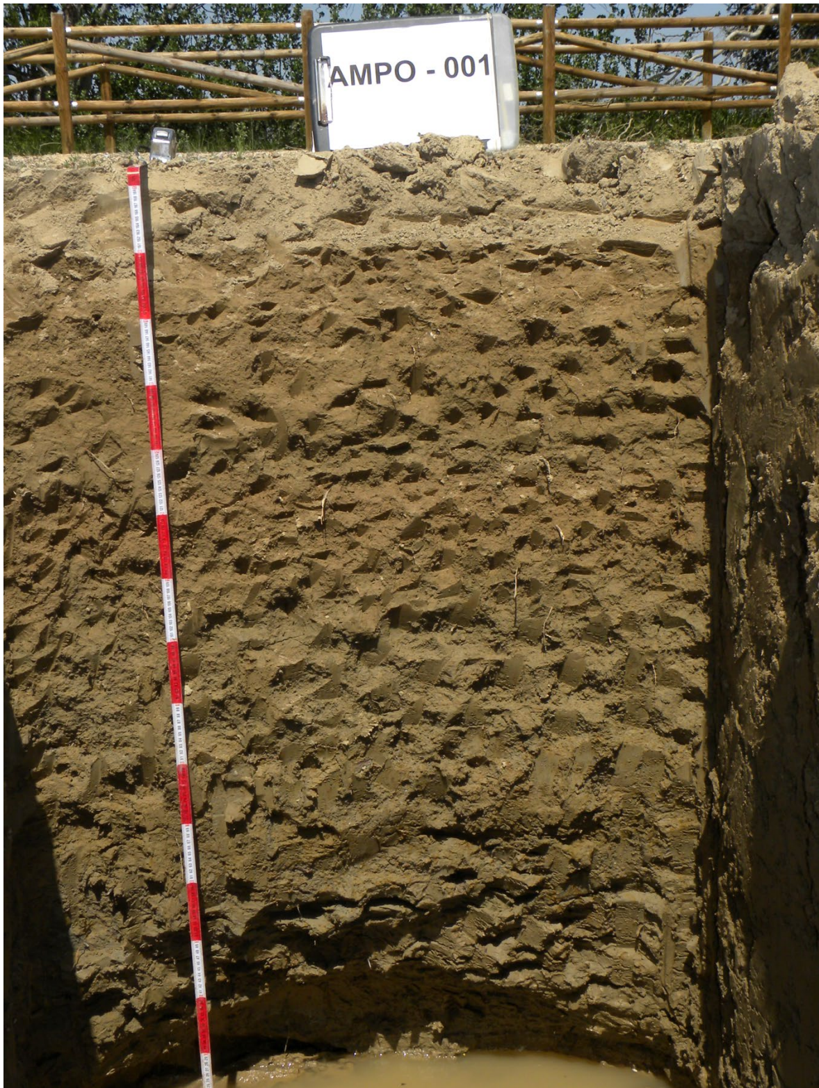
Secuencia de horizontes: Ap1-Apd-Bw1-Bw2-C Cartografía de suelos a escala 1:25.000 de la hoja de Amposta (ICGC, 2014)
