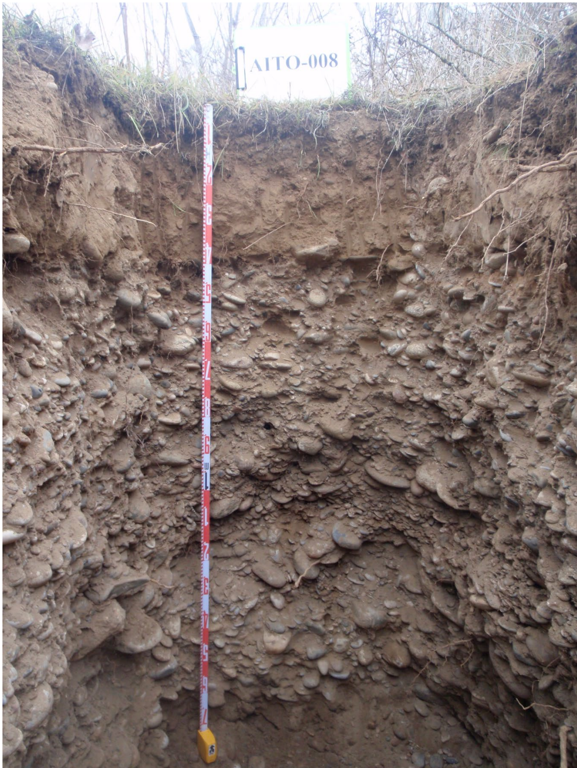
Seqüència d'horitzons: A-Bw-C (graves poligèniques) Cartografia de sòls a escala 1:25.000 del full de Sarroca de Lleida (IGC, 2010)
