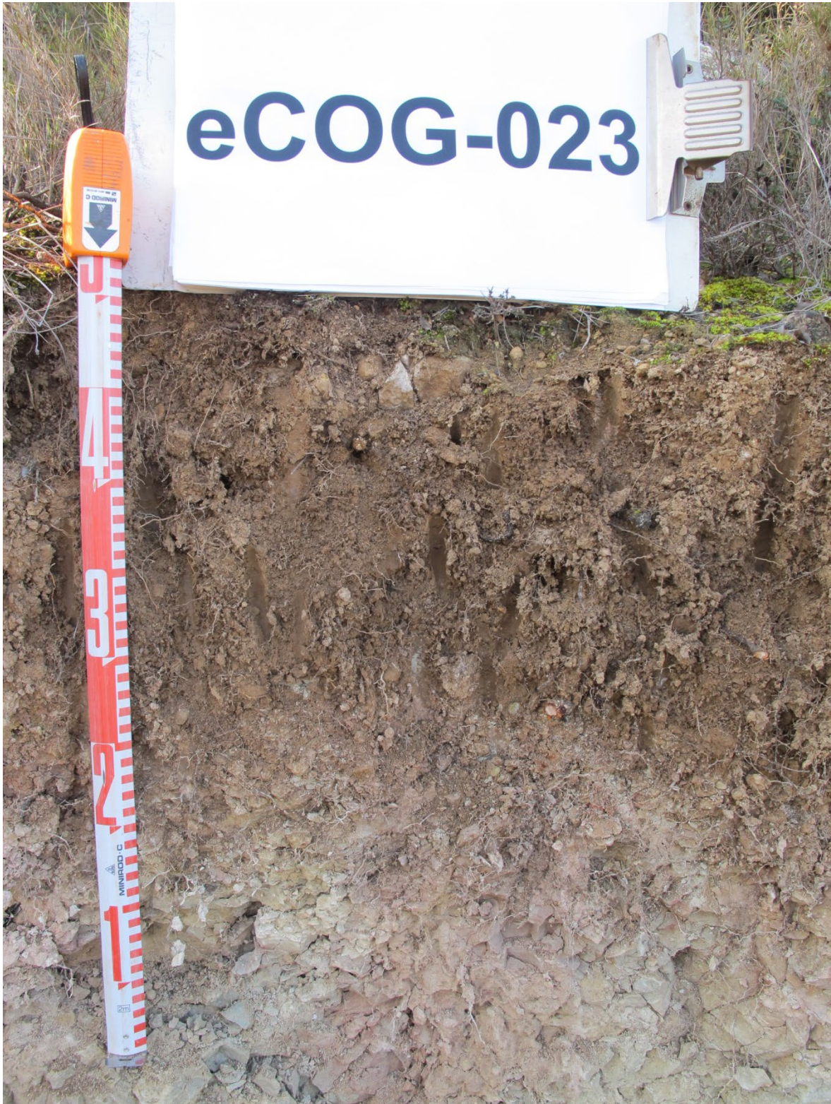
Secuencia de horizontes: Ap-2C (lutita) Cartografía de suelos a escala 1:25.000 de la hoja de Castellans (IGC, 2011)
