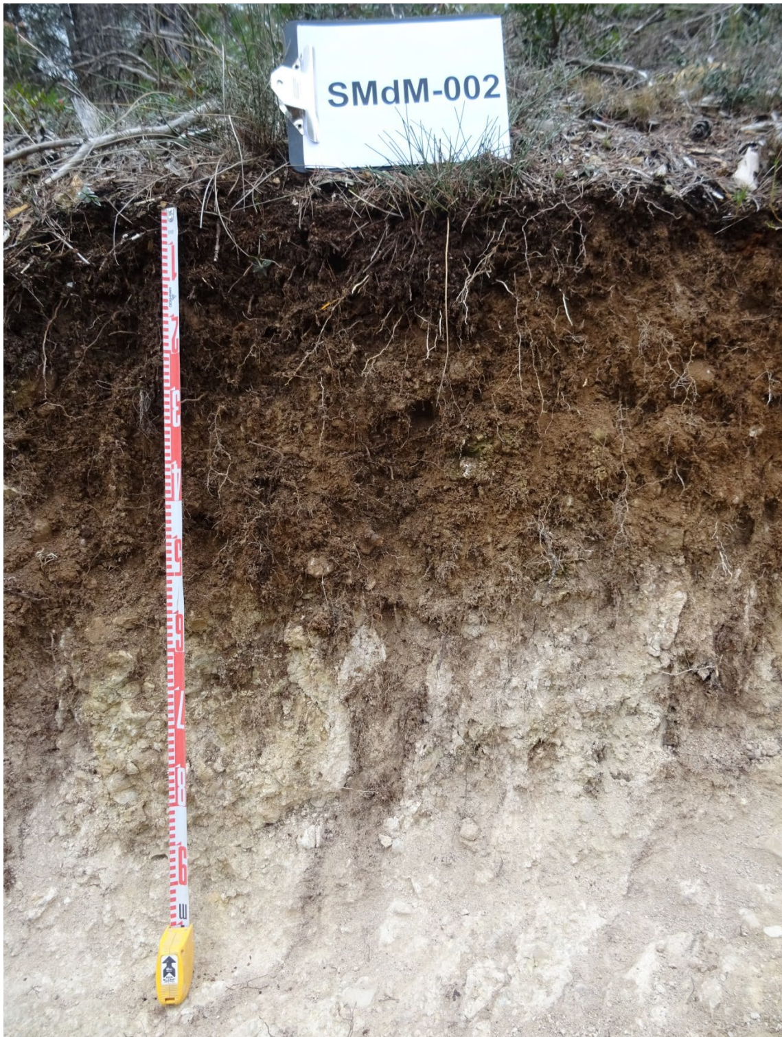
Secuencia de horizontes: Oe-A1-A2-Bk-R (conglomerado). Cartografía de suelos a escala 1:25.000 de la hoja de Igualada (ICGC, 2018)
