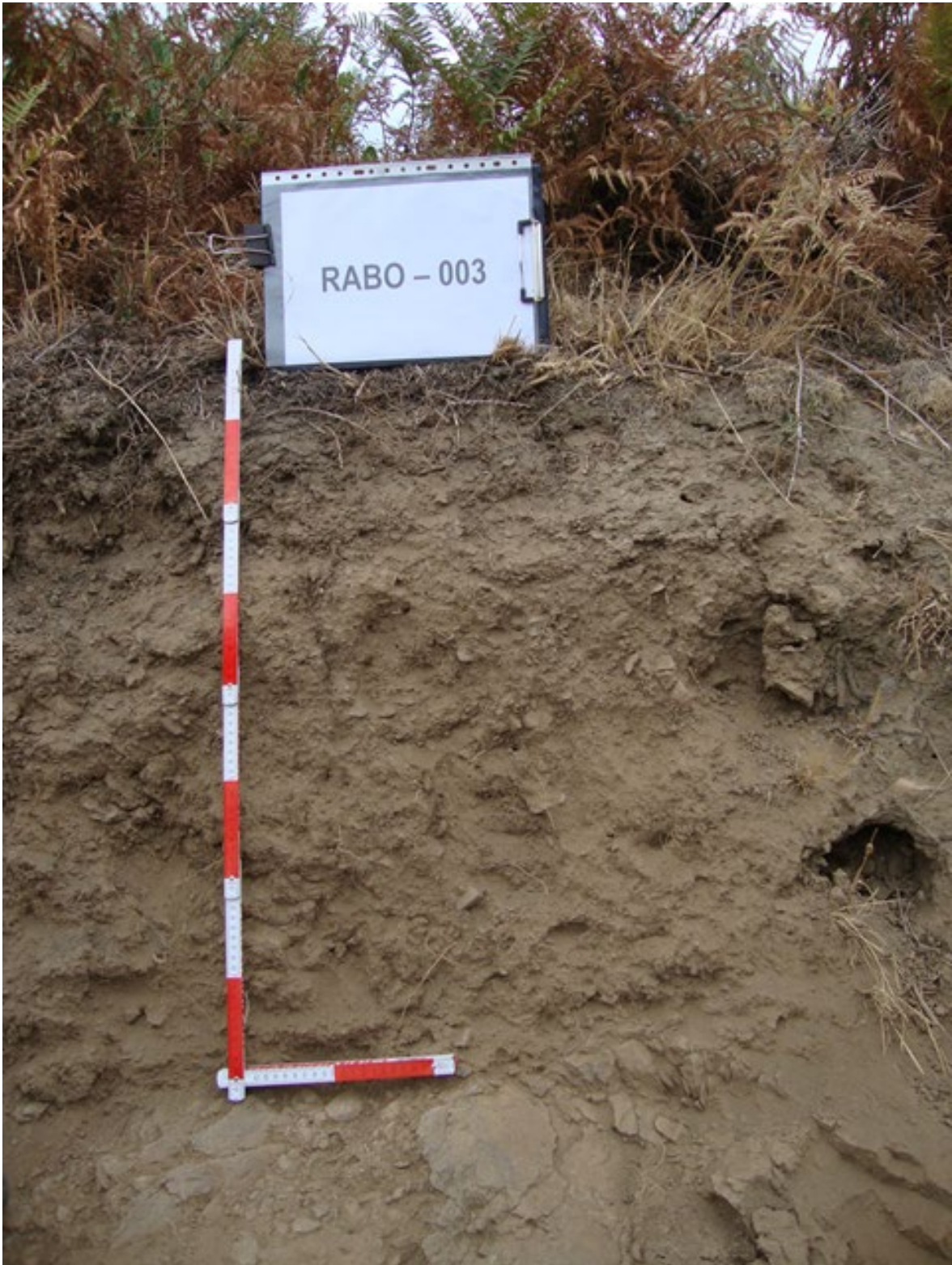
Secuencia de horizontes: (Oi)-A-Bw-R (esquisto). Cartografía de suelos a escala 1:25.000 de la hoja de Banyuls de la Marenda-Portbou (ICGC, 2016).
