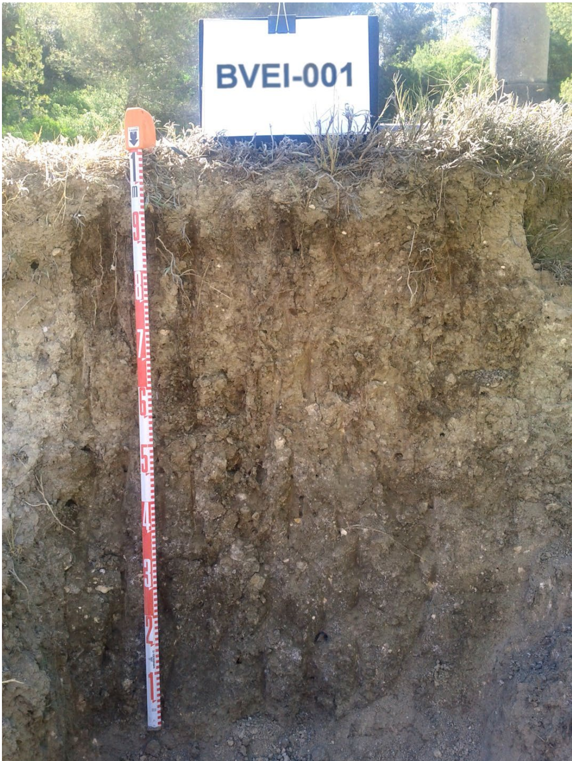
Seqüència d'horitzons: Ap1-Ap2-Bwk-C/R (calcarenita) Cartografia de sòls a escala 1:25.000 del full de el Vendrell (IGC, 2012)
