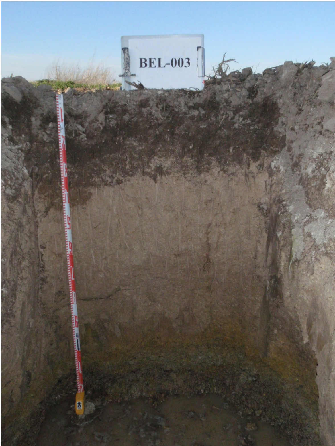
Seqüència d'horitzons: Ap-Bwy1-Bwy2-2C (gres i graves) Cartografia de sòls a escala 1:25.000 del full de Bell-lloc (IGC, 2008)
