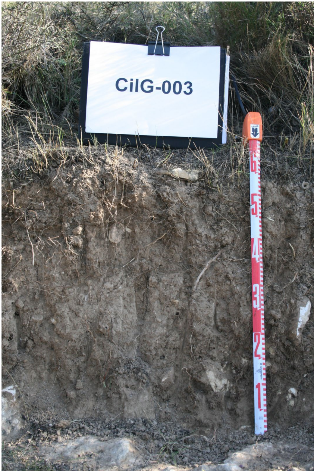
Secuencia de horizontes: A-Bw-R (caliza) Cartografía de suelos a escala 1:25.000 de la hoja de Sant Pere de Ribes (IGC, 2012)
