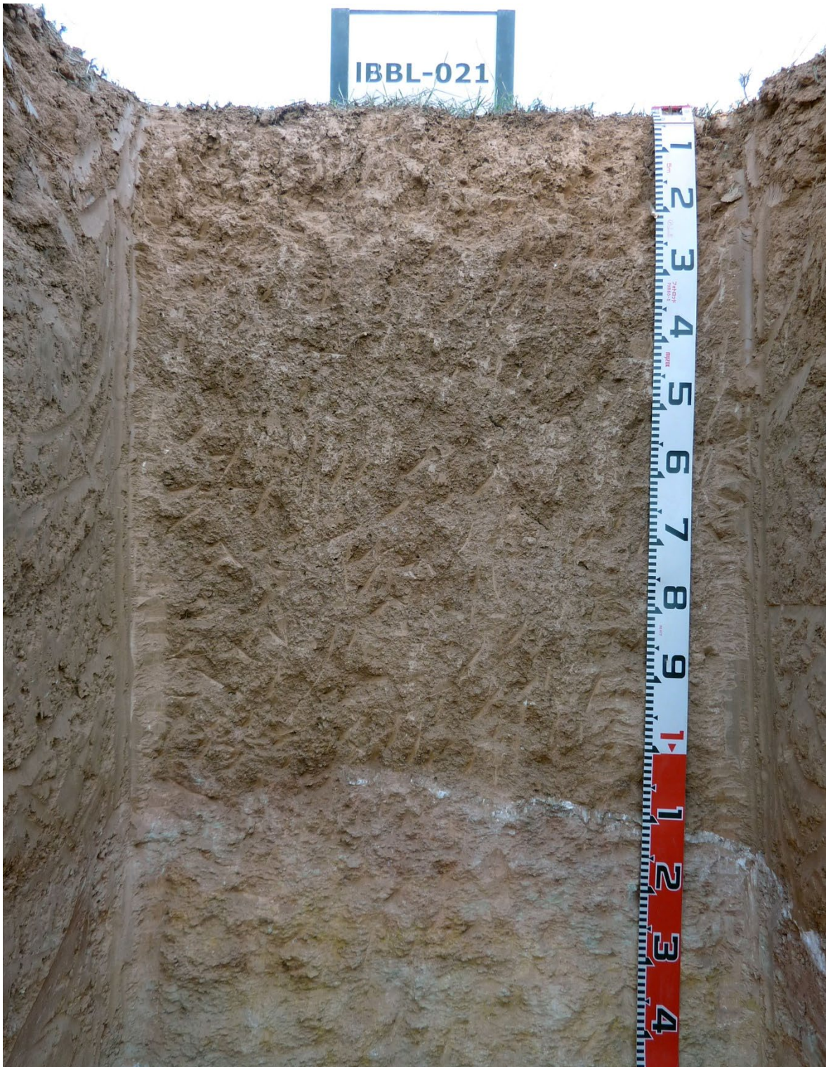
Secuencia de horizontes: Ap-Bw-Bwy-2C (lutita) Cartografía de suelos a escala 1:25.000 de la hoja de Les Borges Blanques (IGC, 2010)
