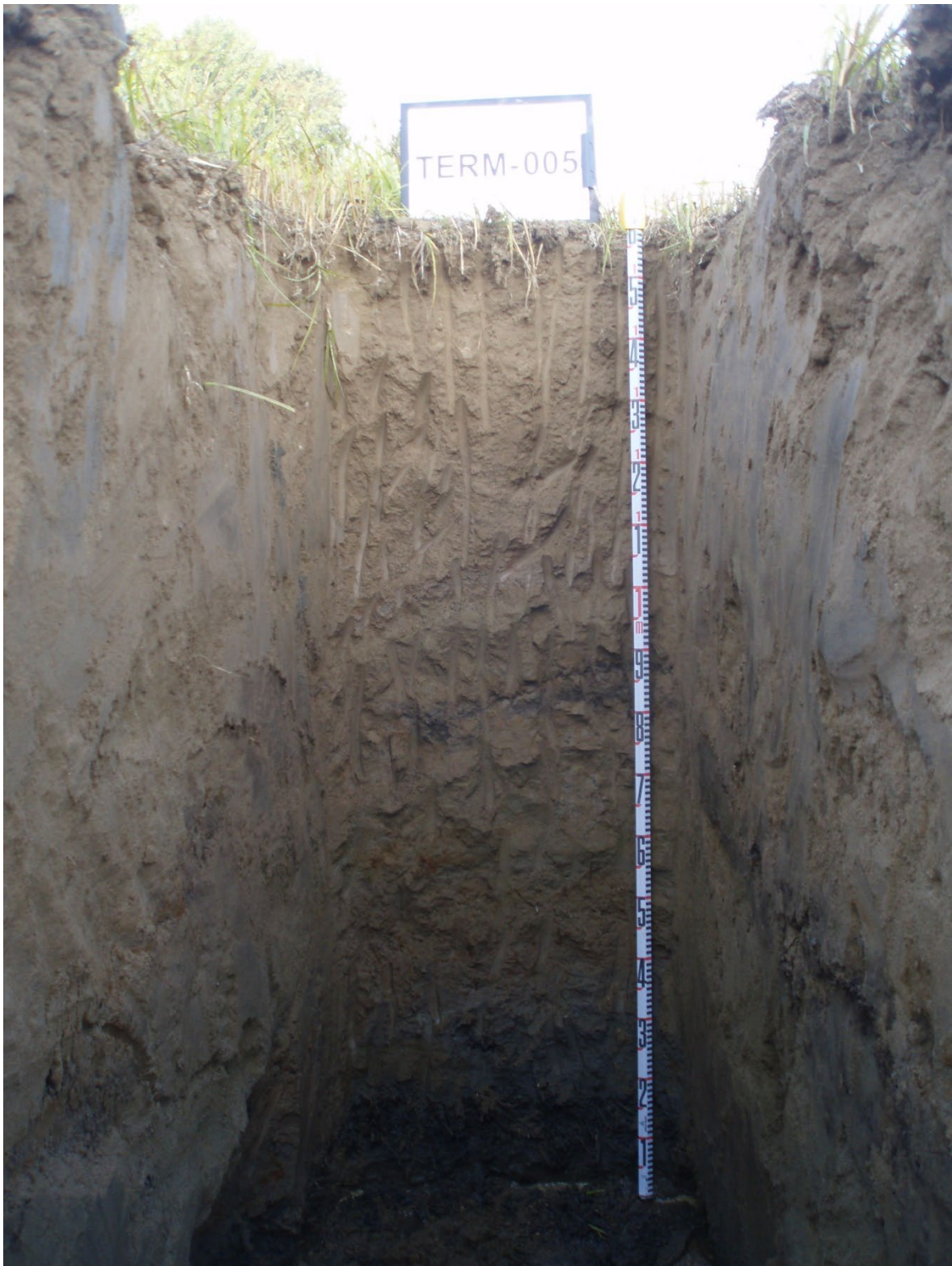
Secuencia de horizontes: Ap-Bw1-Bw2-Bw3-2Oi-3C (gravas poligénicas) Cartografía de suelos a escala 1:25.000 de la hoja de Tèrmens (IGC, 2009)
