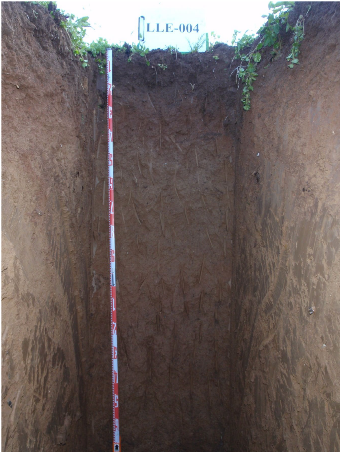
Secuencia de horizontes: Ap1-Ap2-Bw-Bwkn Cartografía de suelos a escala 1:25.000 de la hoja de Bell-lloc d'Urgell (IGC, 2008)
