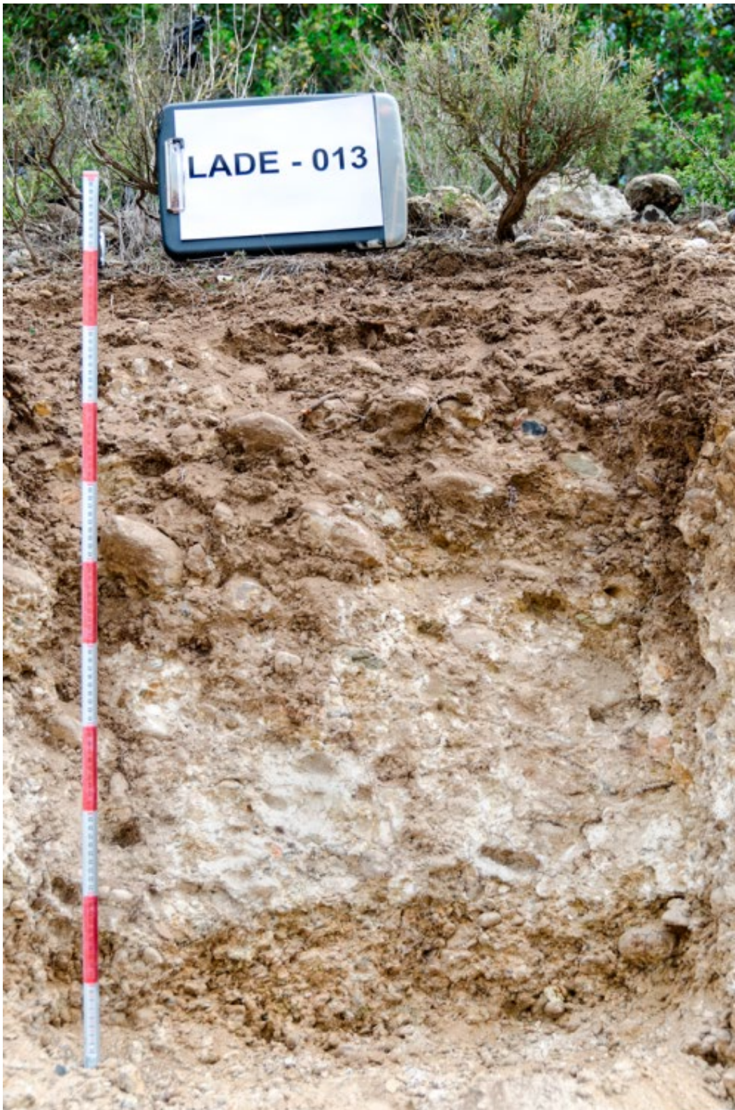
Secuencia de horizontes: A-Bwk-Bkm1-Bkm2 Cartografía de suelos a escala 1:25.000 de la hoja de Amposta (ICGC, 2014)
