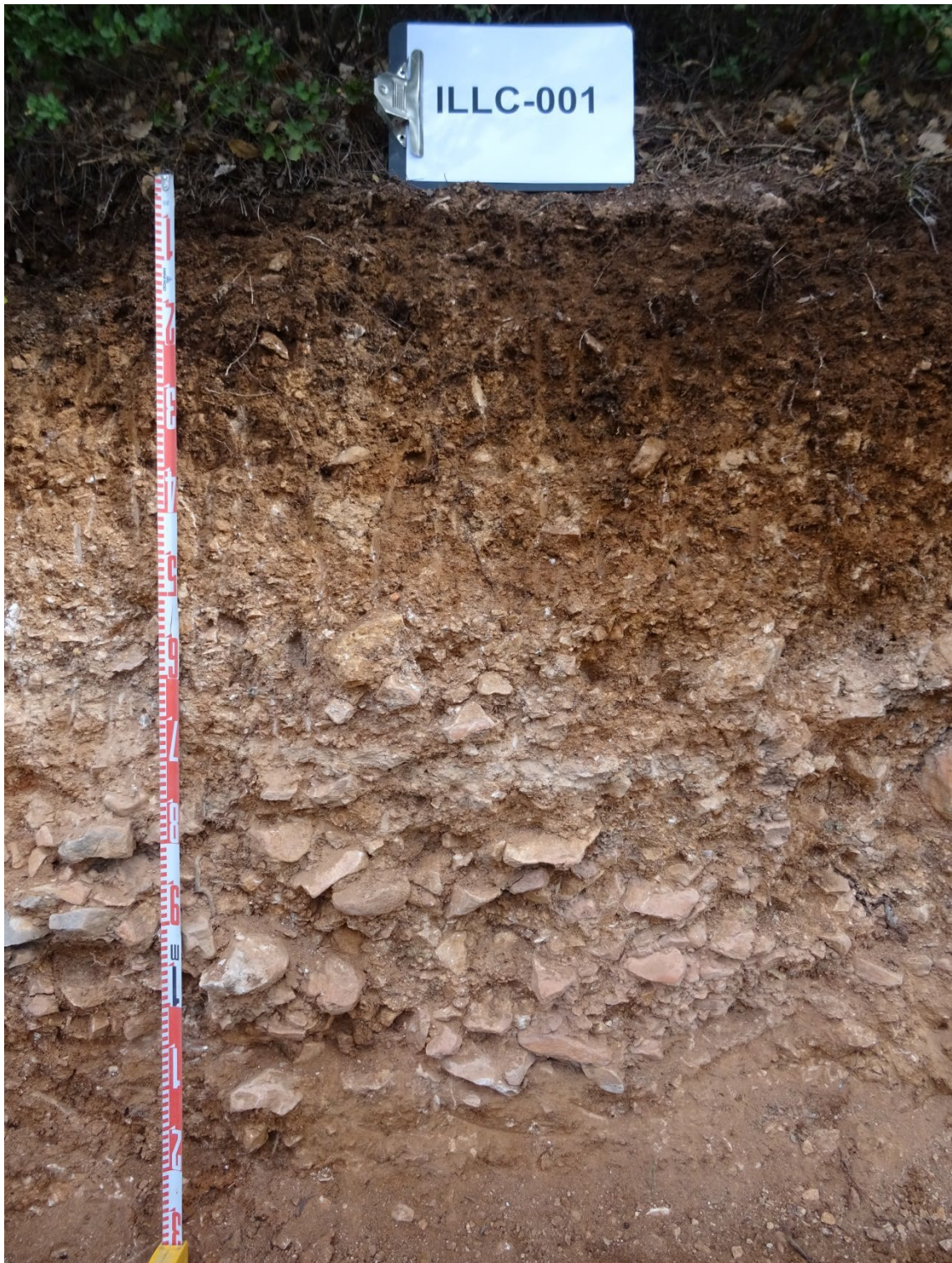
Secuencia de horizontes: A-Bwk-Bk Cartografía de suelos a escala 1:25.000 de la hoja de Igualada (ICGC, 2018)
