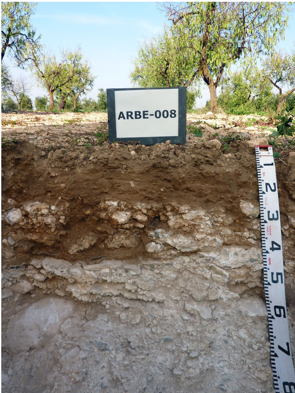
Secuencia de horizontes: Ap-Bkm Cartografía de suelos a escala 1:25.000 de la hoja de las Borges Blanques (IGC, 2010).
